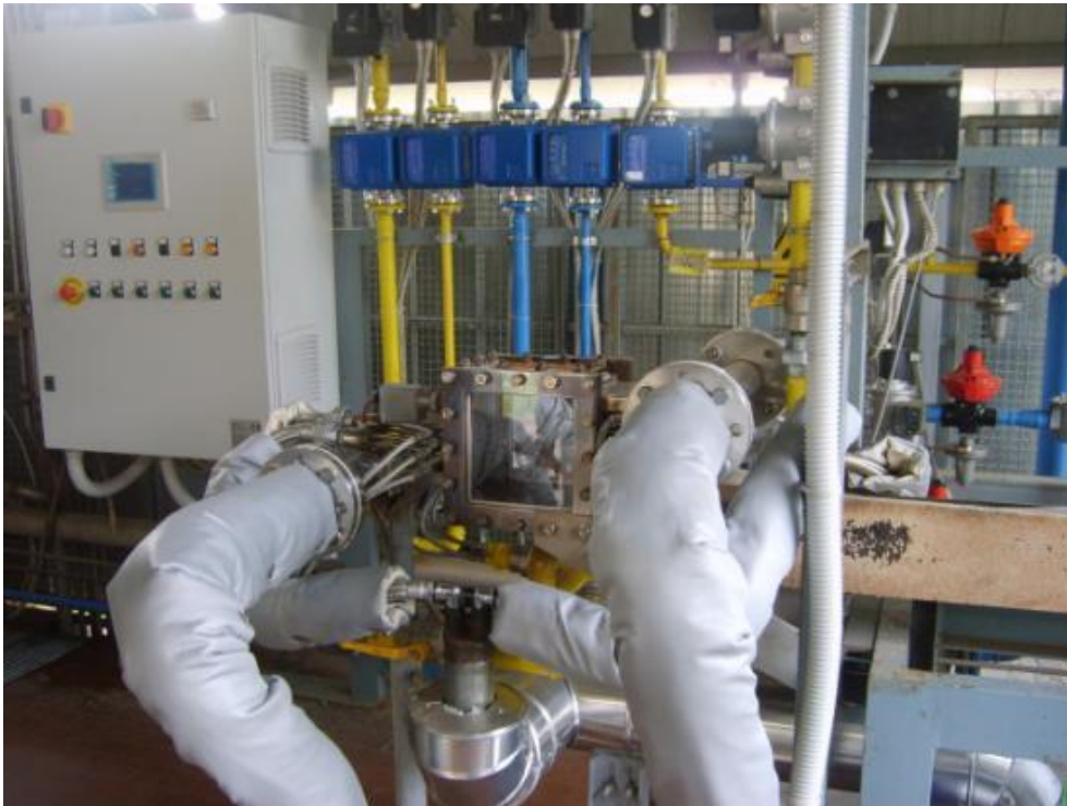
Figura 2. Vista del TVC, dell'impianto di alimentazione e del controllo aria-combustibile.
