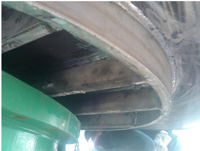
Figura 7 Anello perimetrale di rinforzo del piatto distributore
