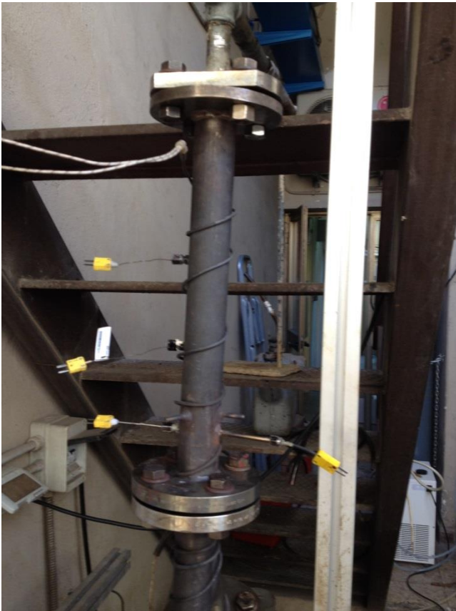
Figura 8: Reattore di reforming.
