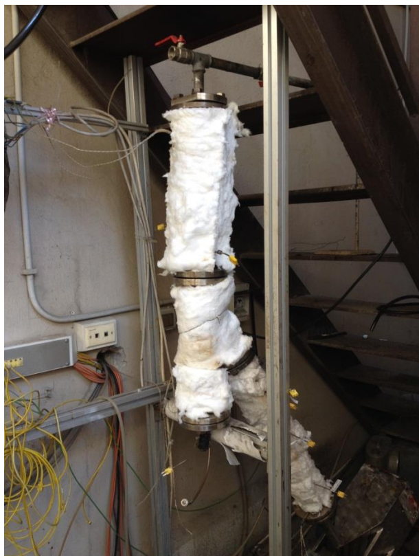
Figura 5: Impianto di gassificazione presso il Dip. di Ingegneria Chimica.
