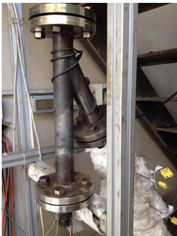
Figura 7: Reattore di gassificazione in configurazione up-draft.
