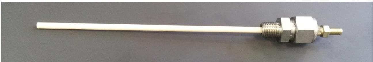
**Figura 10. Testa ottica con fibra di zaffiro monocristallino ( $\Phi = 2 \text{ mm}$ )
