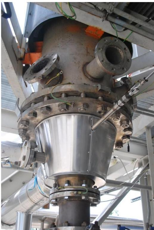
Figura 1. - parte inferiore del gassificatore pilota.
