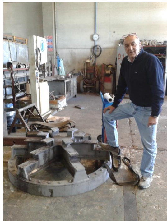
Fig. 2.3 - Viste di insieme del cono di scarico ceneri e basamento griglia mobile
