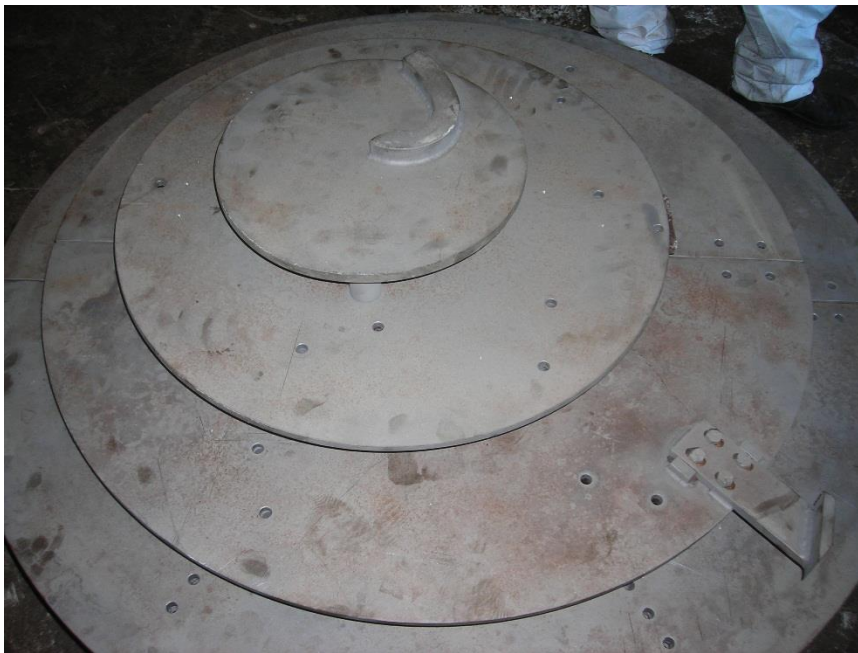
Figura 1.2. La parte esterna della griglia del gassificatore Dimostrativo.
