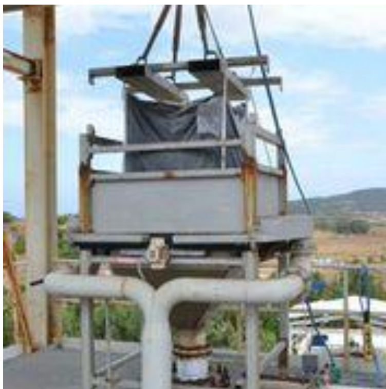
Figura 2.1 Tramoggia del sistema di caricamento del gassificatore.
