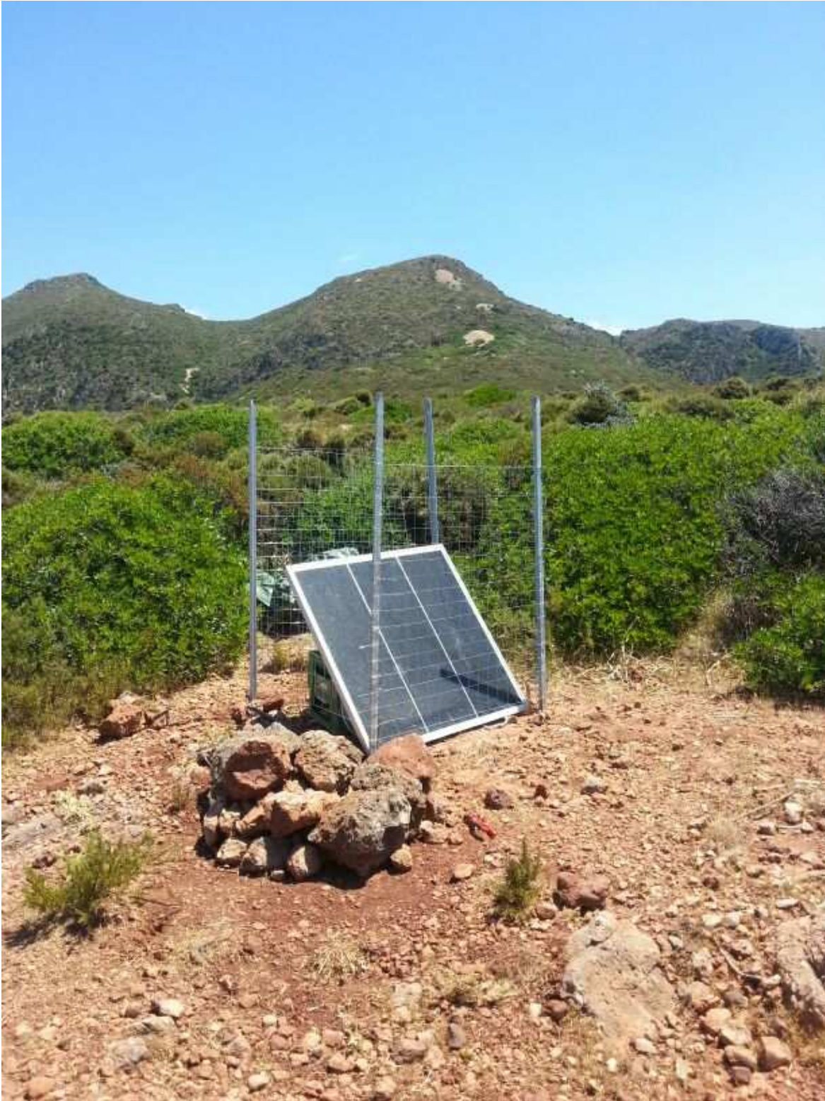
Figura 5.4 – Vista della stazione sismica SU02. La recinzione serve per proteggere la strumentazione dal bestiame. Il cumulo di sassi protegge il sensore dagli animali e dal vento.
