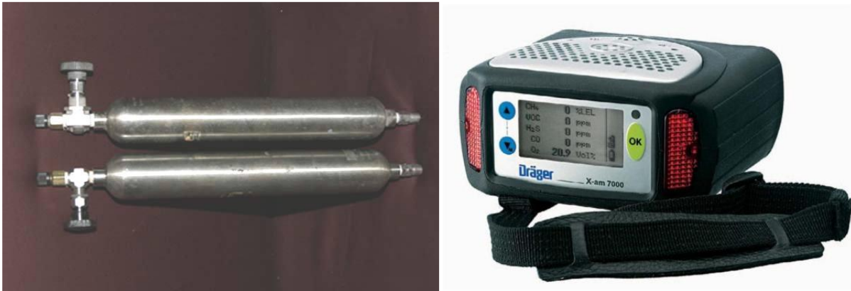
Figura 3 A sinistra, contenitori d'acciaio per la conservazione del campione; a destra, dispositivo con sensori all'infrarosso per le misure in situ di CO 2 , CH 4 , H 2 S, H 2 e O 2 .
