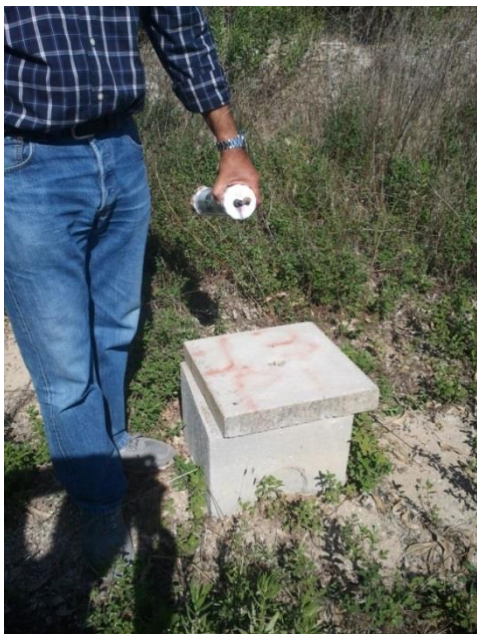
Figura 14. Posizionamento delle sonde nei piezometri
