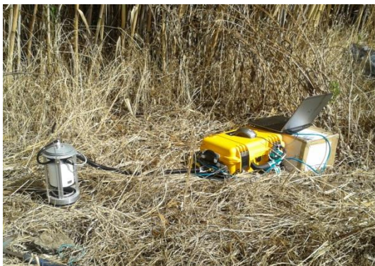
Figura 2 – Strumentazione portatile per la misura della concentrazione e del flusso di CO 2 dal suolo
