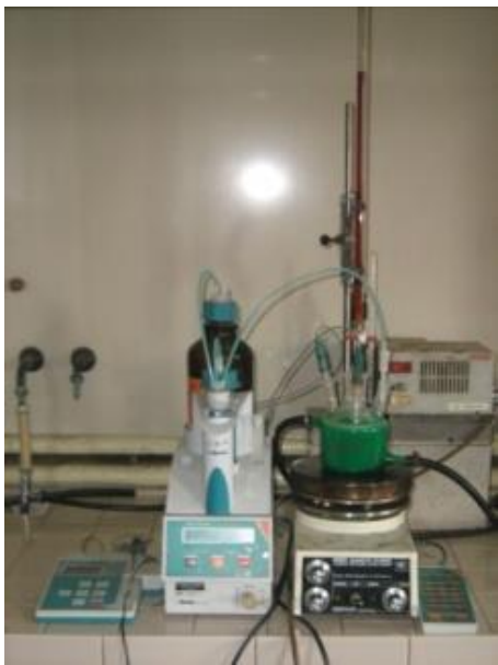
Figura 1.2: Apparato sperimentale per la co-precipitazione (sinistra) e cella incamicciata (destra).
