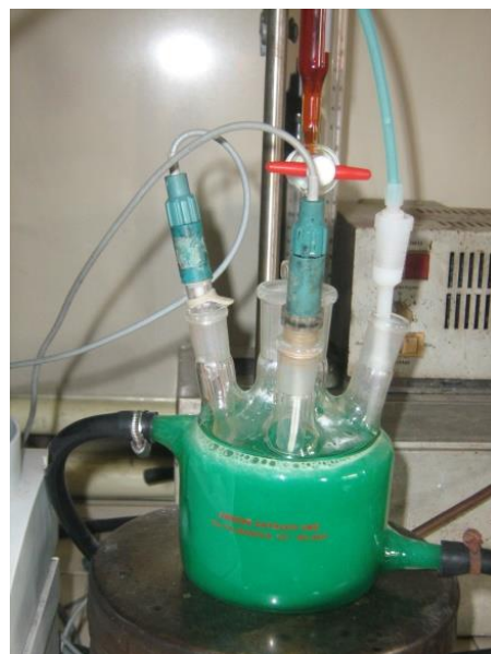
Figura 1.2: Apparato sperimentale per la co-precipitazione (sinistra) e cella incamicciata (destra).
