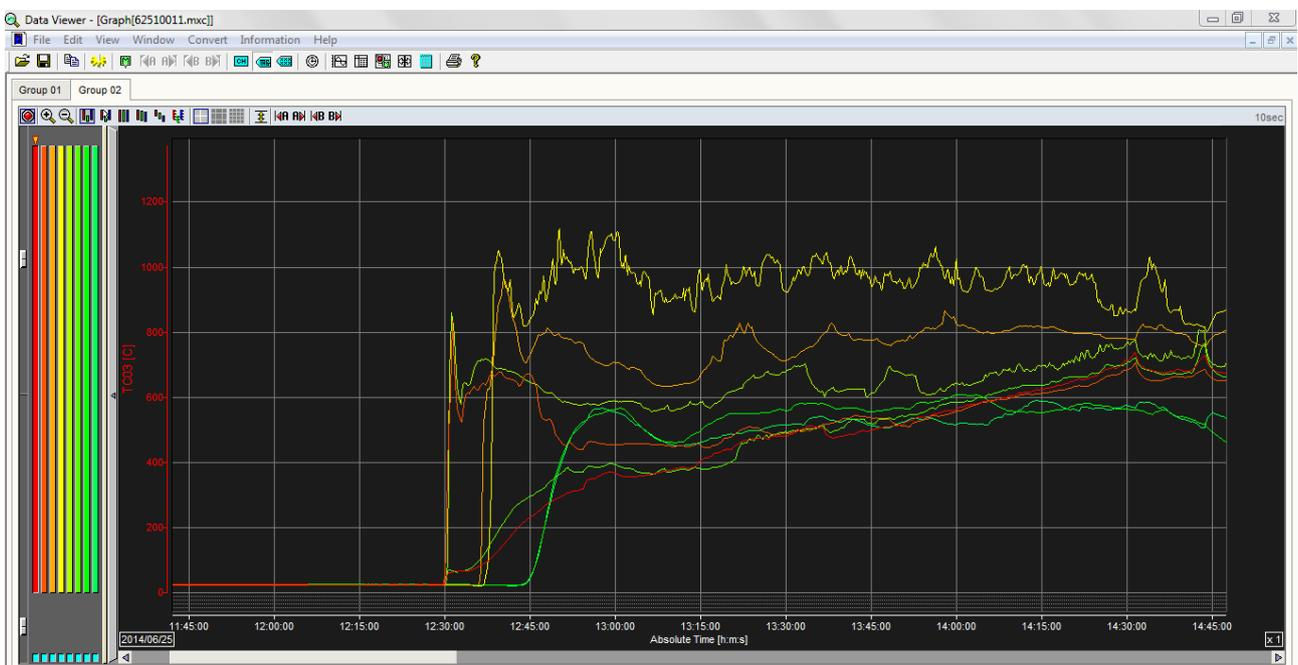
**Figura 13. Andamento delle temperatura interne in avviamento
