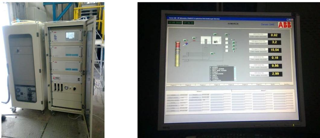
**Figura 6: Analitica modulare e sinottico di interfaccia con l’operatore**
