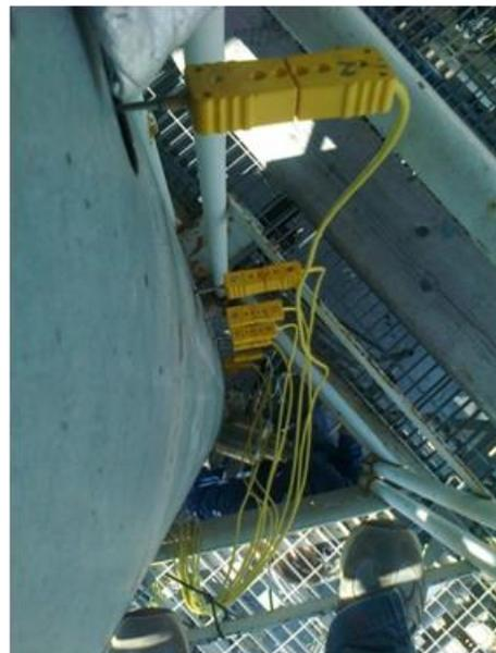
**Figura 17. Impianto Piattaforma Pilota: monitoraggio termico del gassificatore**
