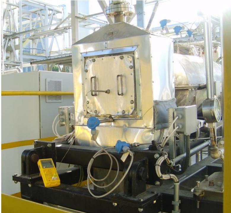
Figura 6 - VALCHIRIA - Pirolizzatore lato camera di calma; misure di temperatura.
