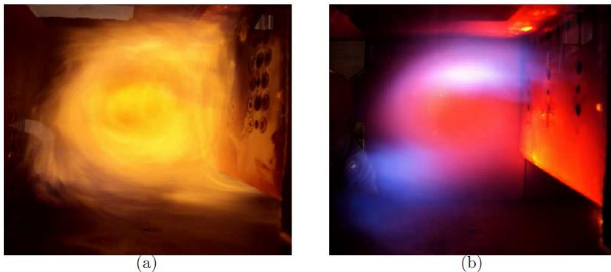
Figura 4. (a) immagine della fiamma nello spettro del visibile ottenuta in condizioni di miscela grassa; (b) immagine della fiamma ottenuta in condizioni di miscela magra.
