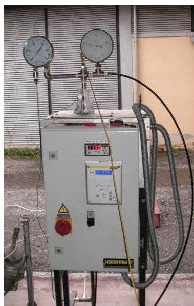
Figura 8: Alloggiamento del reattore nel forno e manometri di misura della pressione e delle perdite di carico durante un test a 5 bar
