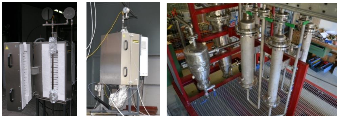
Figura 6: Forno di alloggiamento del reattore e reattori multi tubolari in serie
