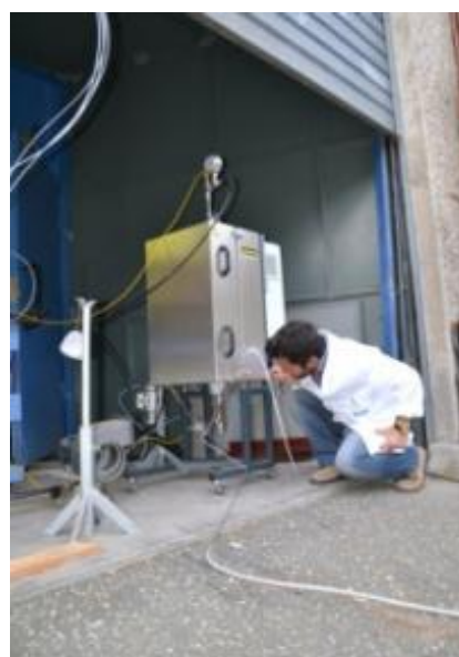
Figura 11: Foto di preparazione di un campione di catalizzatore e controllo dell'alloggiamento del reattore
