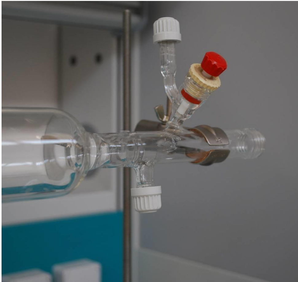
Figura 3.11. Condotto di adduzione gas (Sono identificabili il bocchello per l'inserimento della sonda di controllo ed il bocchello predisposto per l'alimentazione ausiliaria, dotato di rubinetto)
