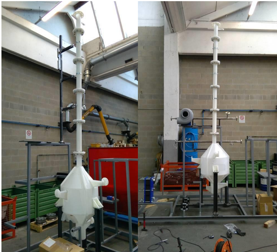
Figura 6-3 Particolari della colonna di assorbimento
