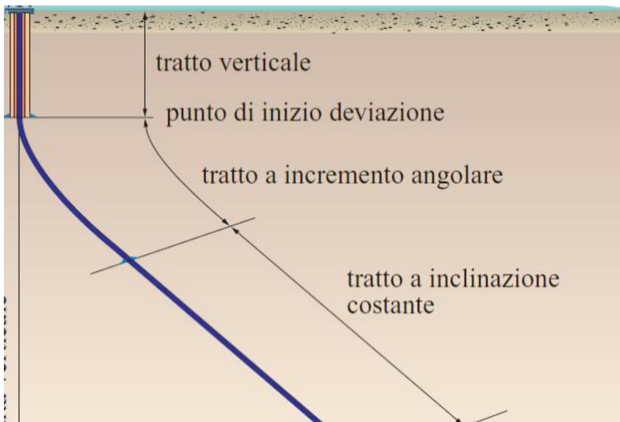
Figura 28: Schematizzazione sondaggio geognostico deviato
