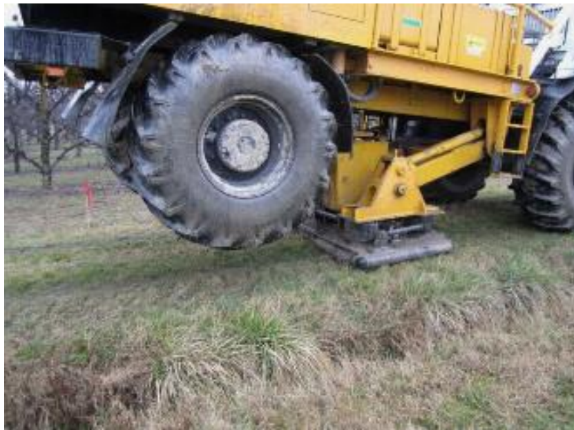
Figura 23: Piastra vibrante appoggiata al suolo per energizzazione
