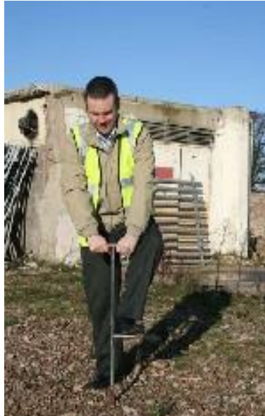
Figura 13: Modalità di infissione della sonda
