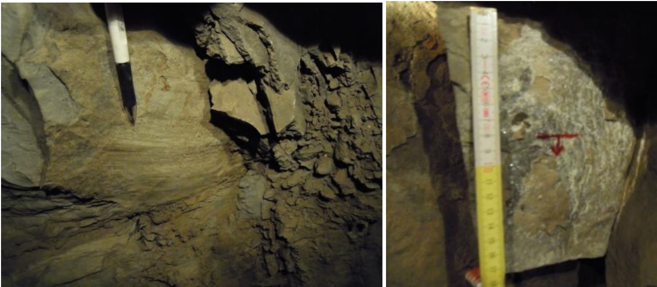
Figura 3 – Nelle due foto sono rappresentate le strie in roccia (a sinistra) e con fibre di calcite (a destra) presenti sulle superfici di faglia appartenenti al sistema coniugato trascorrente 250^\circ/150^\circ (la freccia rossa rappresenta la direzione di immersione del piano; la fascia bianca corrisponde allo scalino normale alla fibra di calcite).
