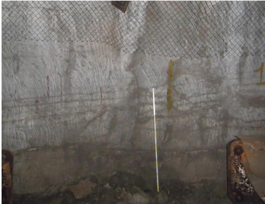
Figura 7– Sistema di faglie a basso angolo. Notare la variazione di spessore tra il tetto e il letto delle faglie.
