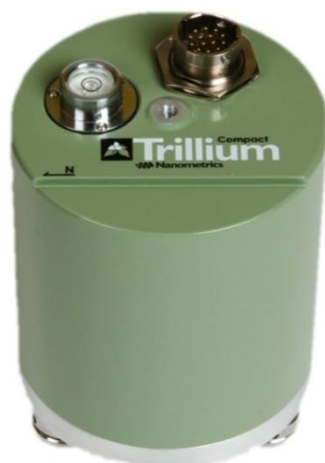
Figura 3.2 Immagini dei sensori sismici: a sinistra il sensore Lennartz LE3D/5s; a destra il sensore Nanometrics Trillium Compact 120s (le immagini non sono in scala relativa tra i due oggetti, il LE3D/5s è più grande del Nanometrics).
