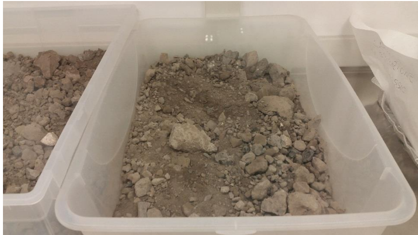
Figura 1. Scoria da convertitore ad ossigeno (BOF)
