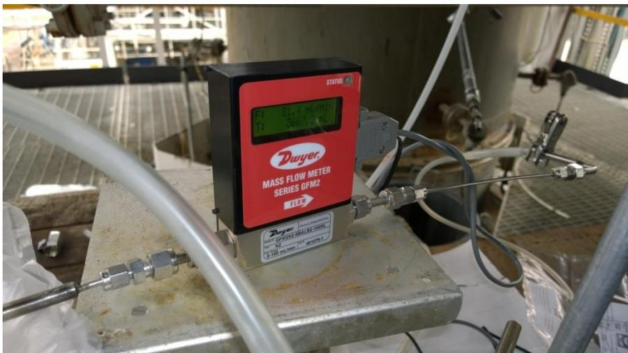
**Figura 13. Allestimento del contatore di gas Dwyer, Serie GFM2, nel campionamento del giorno 09 settembre 2015.**
