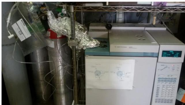
Figura 14. Strumentazione utilizzata per l'analisi del syngas.
