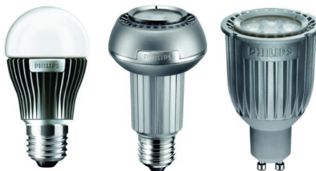
Fig. 13 - Lampade Philips MasterLED da 7W: la prima sostituisce un'incandescenza da 40W, la seconda un'incandescenza con riflettore sempre da 40W e fascio 25° o 40°, la terza una lampada ad alogeni con riflettore dicroico da 35W con fascio da 25° o 40°.
