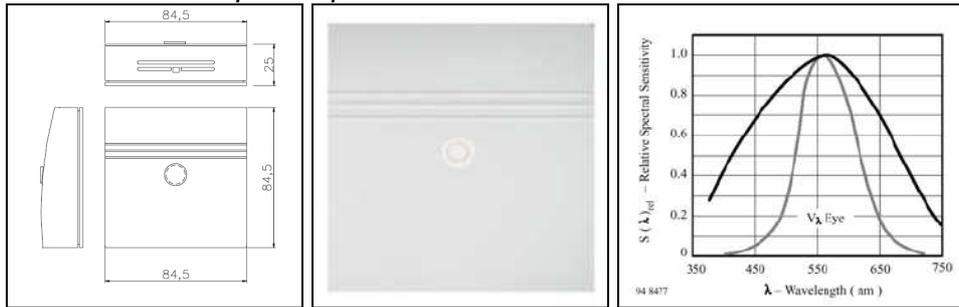
**Sensore di occupazione WRF 041** (ditta Thermokon) presenta una modalità di lettura su piano orizzontale con tecnologia di rilevamento ad infrarosso. L'angolo massimo del campo di lettura è 100°. Il tempo di ritardo dello spegnimento può essere previsto tra 1s e 30 minuti (Figura 3.11)
