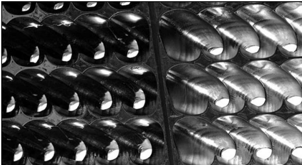
Figura 1.63. Fotografia dell'apertura d'uscita del dispositivo anidolico: una cella appare luminosa solo se la direzione della vista è all'interno del settore d'emissione.
