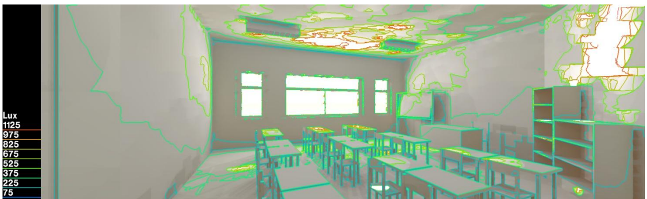
Figura 5.32. 21 Giugno Cielo Sereno ore 12, limite massimo di penetrazione della luce diurna: valori di illuminamento in presenza dei sistemi di daylighting e PSALI
