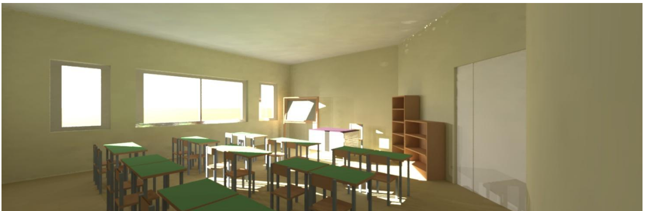
Figura 5.18. Simulazione della luce naturale nell'aula col software Radiance
