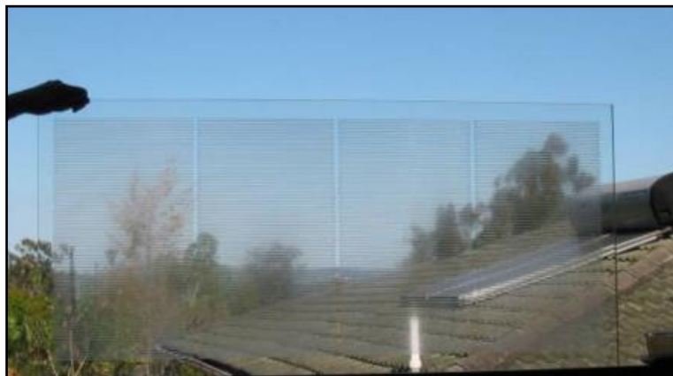
Figura 1.27. Vista attraverso un pannello laser-cut
