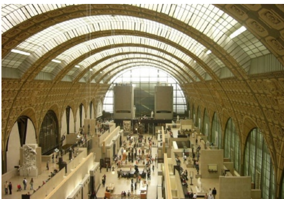
Fig. 118 - Musée d'Orsay, Parigi. Il progetto di Gae Aulenti nasce in funzione del controllo della luce naturale. La luce artificiale è integrata agli stessi sistemi che convogliano la luce diurna (progetto illuminotecnico Piero Castiglioni).
