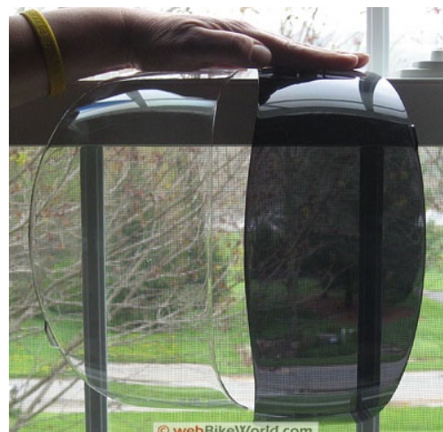
Fig. 23 - Schermo per casco in materiale fotocromico prima e dopo l'esposizione alla luce naturale.
