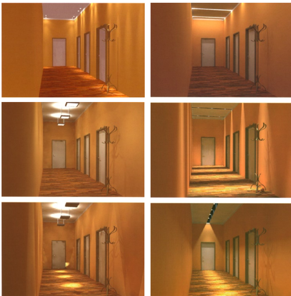
Fig. 99 - Illuminazione di un ingresso con varie tipologie di impianto (Arcesilai, Weissenberg)
