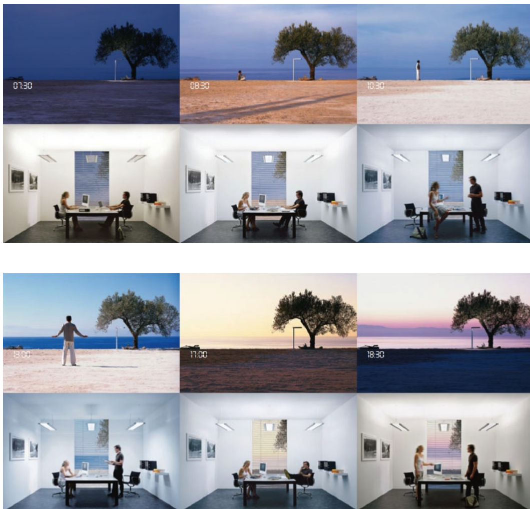
Fig. 91 - La possibilità di controllare, oltre alla quantità di luce, anche la qualità (cioè la temperatura di colore e la prevalenza della componente diretta o indiretta) consente di ottenere il perfetto bilanciamento tra ambiente, energia e benessere dell'individuo (Zumtobel).
