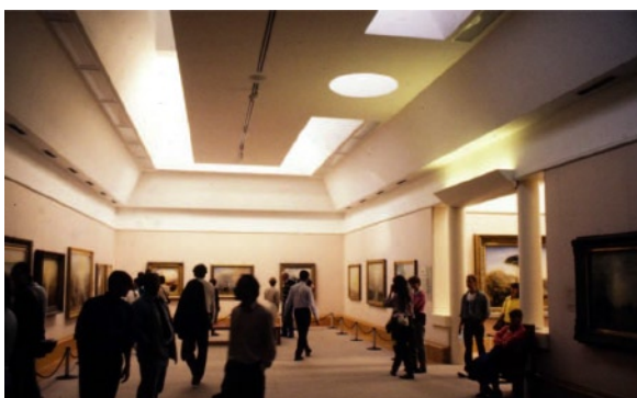
Fig. 121 - Clore Gallery, Londra di Stirling e Wilford. L'integrazione di luce naturale e artificiale è controllata con sistemi meccanizzati per mantenere costante la luminosità interna.
