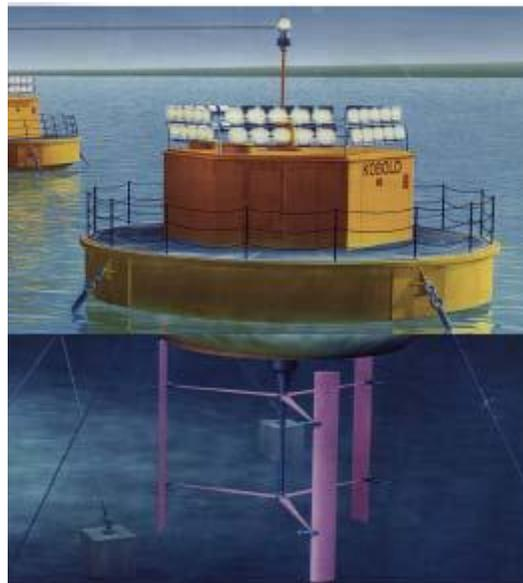
**Figura 2. Visione pittorica della installazione della turbina ad asse verticale Kobold.**
