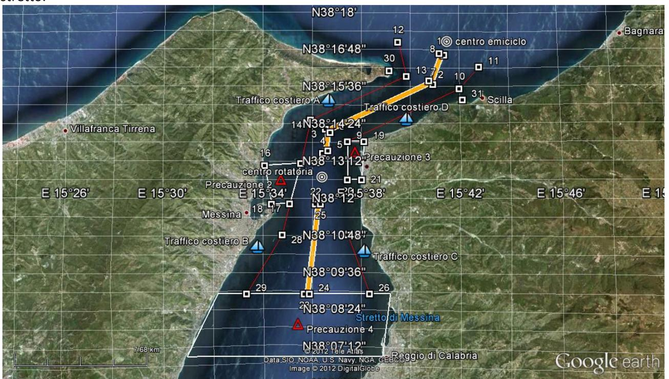
**Figura 22. Aree destinate alla navigazione e di precauzione. Limiti pratici alla installazione di impianti.**
