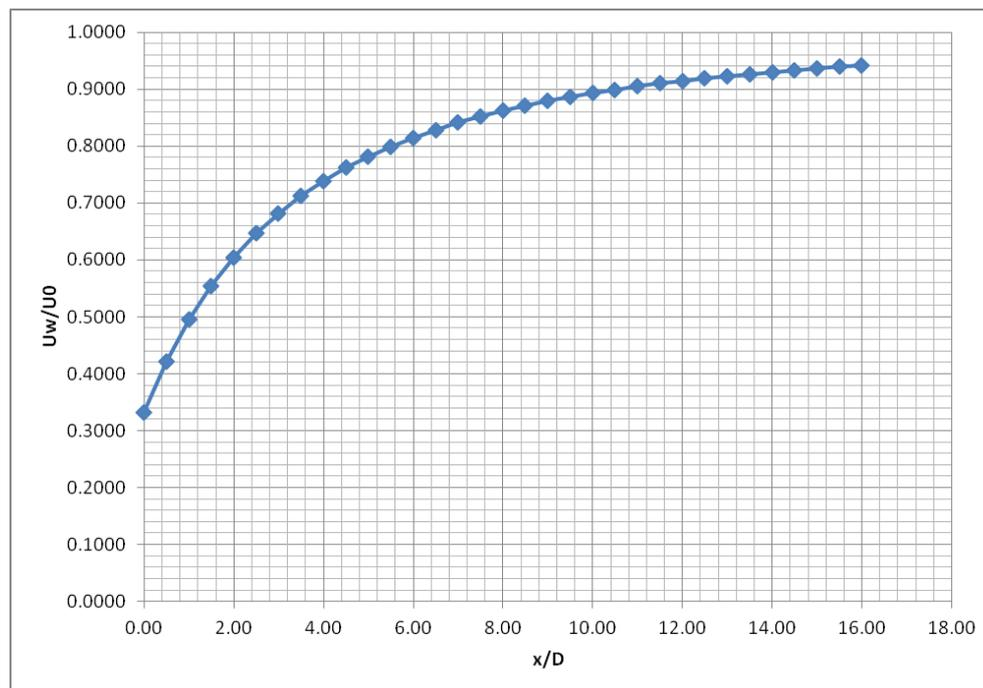
**Figura 8. Andamento della velocità nella scia di una turbina secondo il modello semplificato di Jensen, in funzione della distanza a valle della turbina adimensionalizzata rispetto al diametro.  $C_T=0.89$ ,  $k=0.075$**
