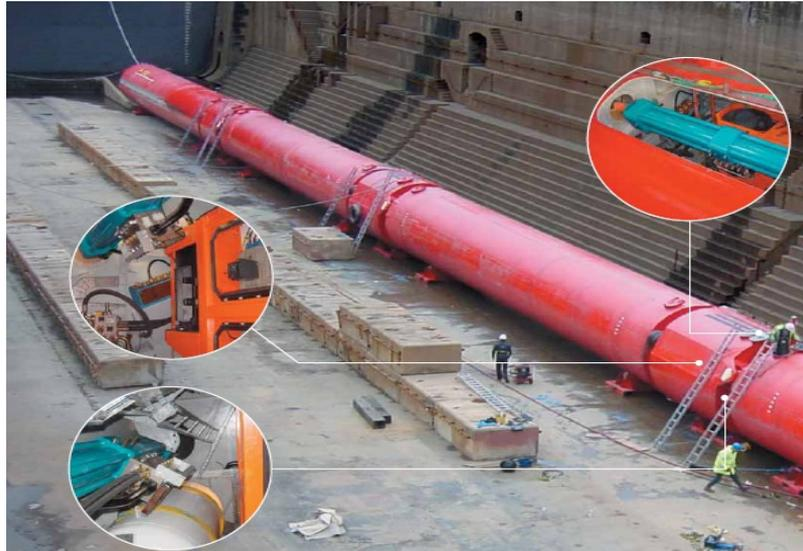
Figura 4.1 - Dettagli dei moduli di conversione dell'energia del Pelamis.
