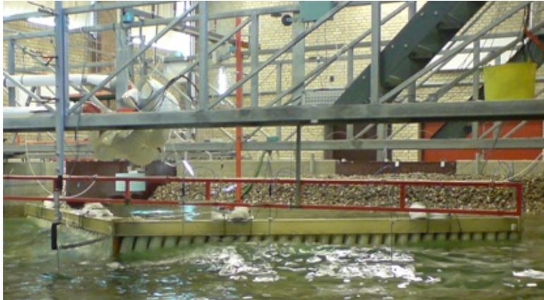
Figura 7.16 - Configurazione galleggiante senza l'impiego di piatti.
