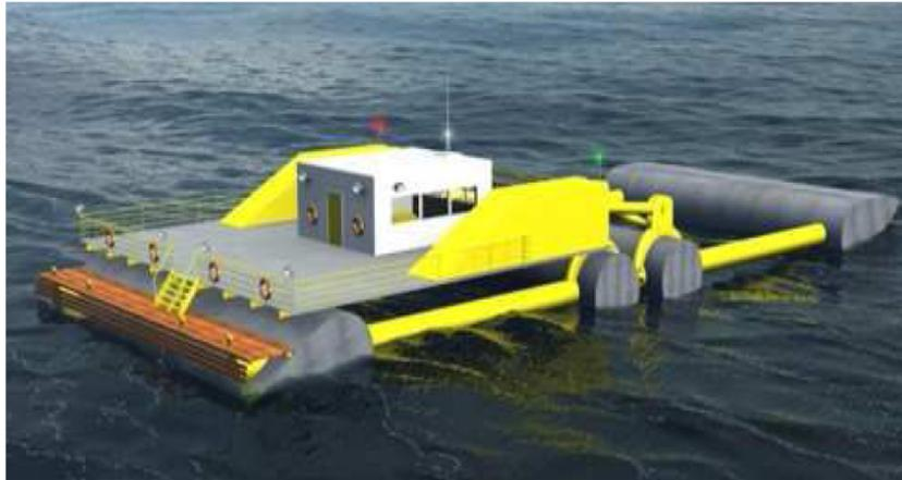
Figura 2.9 - Esempio di dispositivo di conversione dell'energia da onda, chiamato DEXA
