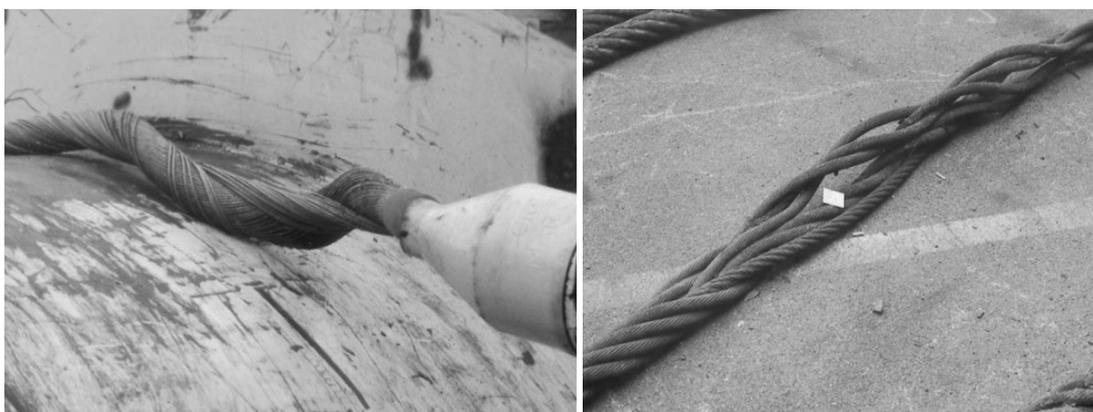
Figura 6.5 – Tipiche modalità di rottura (Chaplin 1998). A sinistra: danno in un filo a spirale a causa dell'elevata torsione di carico. A destra: Danno di sfilamento in un trefolo a sei cavi.
