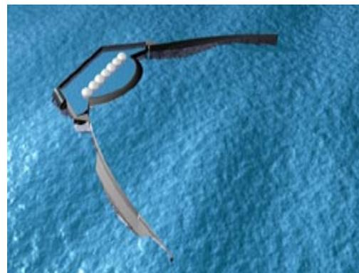
Figura 2.5 - Schema del dispositivo a tracimazione offshore *Wave Dragon*
