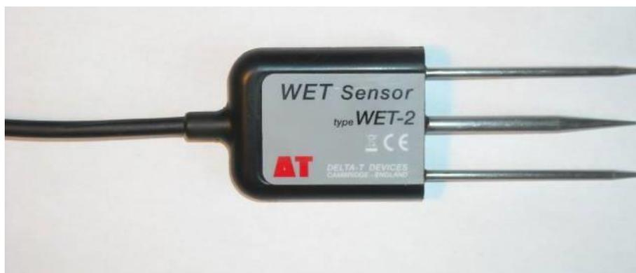
**Figura 6. Sensore FDR WET della Delta –T Devices per la misura del contenuto idrico volumetrico e della conducibilità elettrica della soluzione circolante.**
