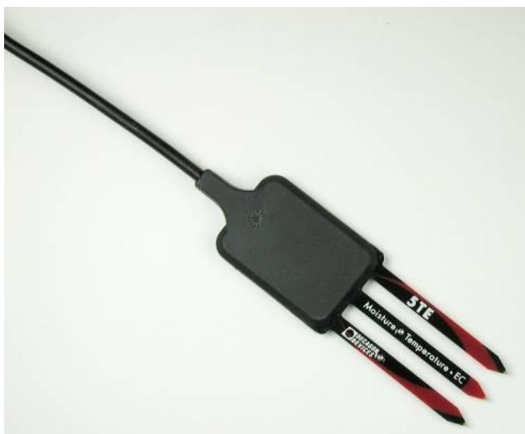
**Figura 7. Sensore FDR EC 5TE della Decagon Devices per la misura del contenuto idrico volumetrico e conducibilità elettrica della soluzione circolante: la misura della EC viene fatta attraverso le due viti inserite su due dei tre pin.**
