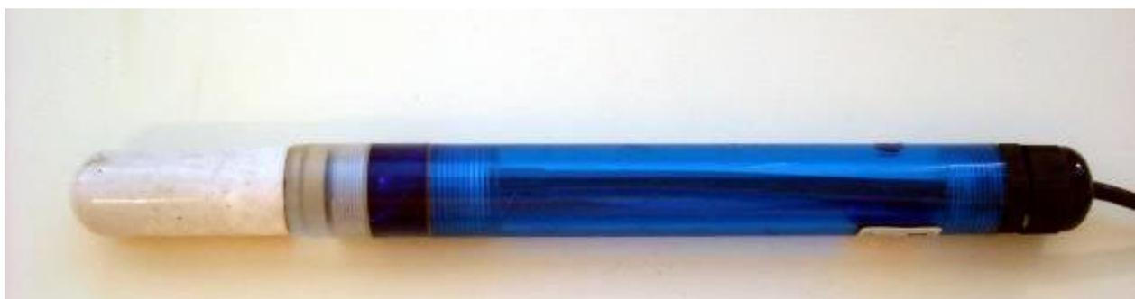
**Figura 4. Tensiometro idraulico**
