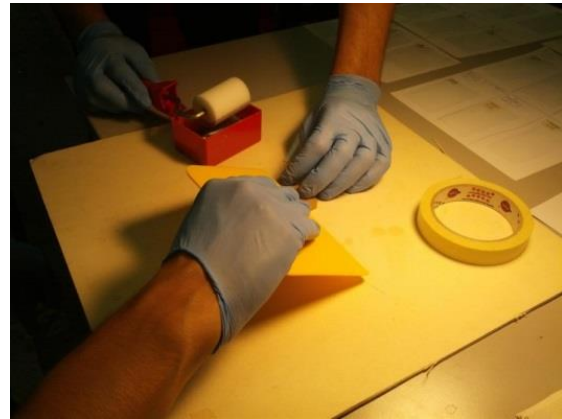
Fig. 45 - Rimozione della resina eccedente tramite spatolatura
