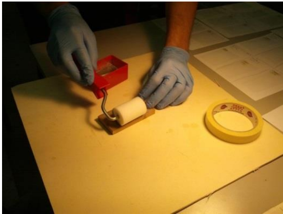
Fig. 44 - Depositione della resina tramite rullo per vernici acriliche
