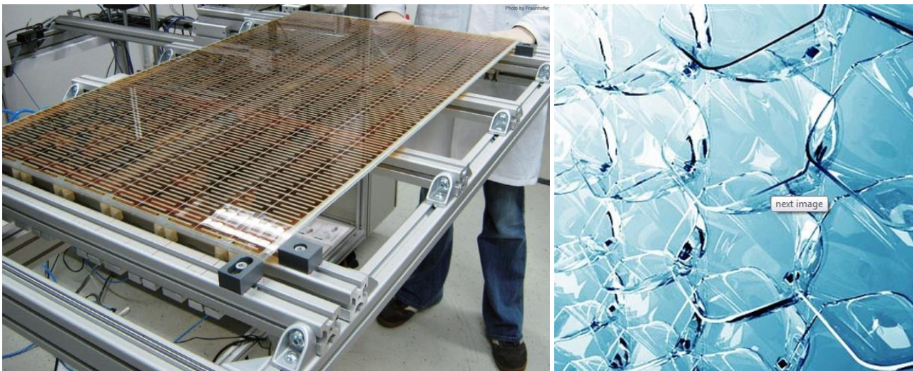
Fig. 7 – Integrazione di fotovoltaico in facciata. A sinistra un modulo con PV organico integrato (prototipo sviluppato presso il Fraunhofer Institute - ISE). A destra un sistema a concentrazione solare. Entrambi i sistemi possono fungere contemporaneamente da protezione solare e da componente attivo nella trasformazione di energia (fonte: a sinistra http://www.interpv.net ; a destra http://www.inhabitat.com )
