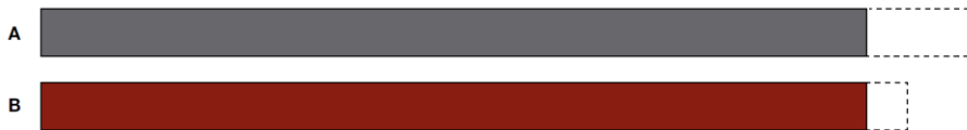
Fig. 55 – Strisce disgiunte di materiali diversi prima e dopo (parte tratteggiata) il riscaldamento
