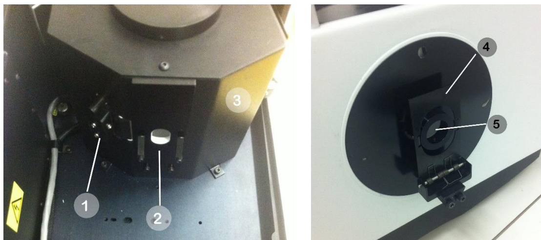
Fig. 24 – Porta di trasmittanza (sinistra) e porta di riflettanza (destra): 1) Porta da aprire per misure di riflettanza diffusa; 2) Supporto campioni per la porta di trasmittanza; 3) Sfera; 4) Supporto campioni per la porta di riflettanza; 5) Porta di riflettanza.
