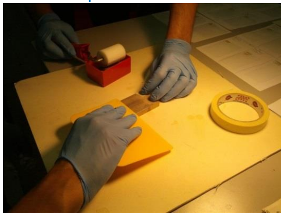
Fig. 46 - Rifinitura del deposito e controllo dell'uniformità dello strato di resina
