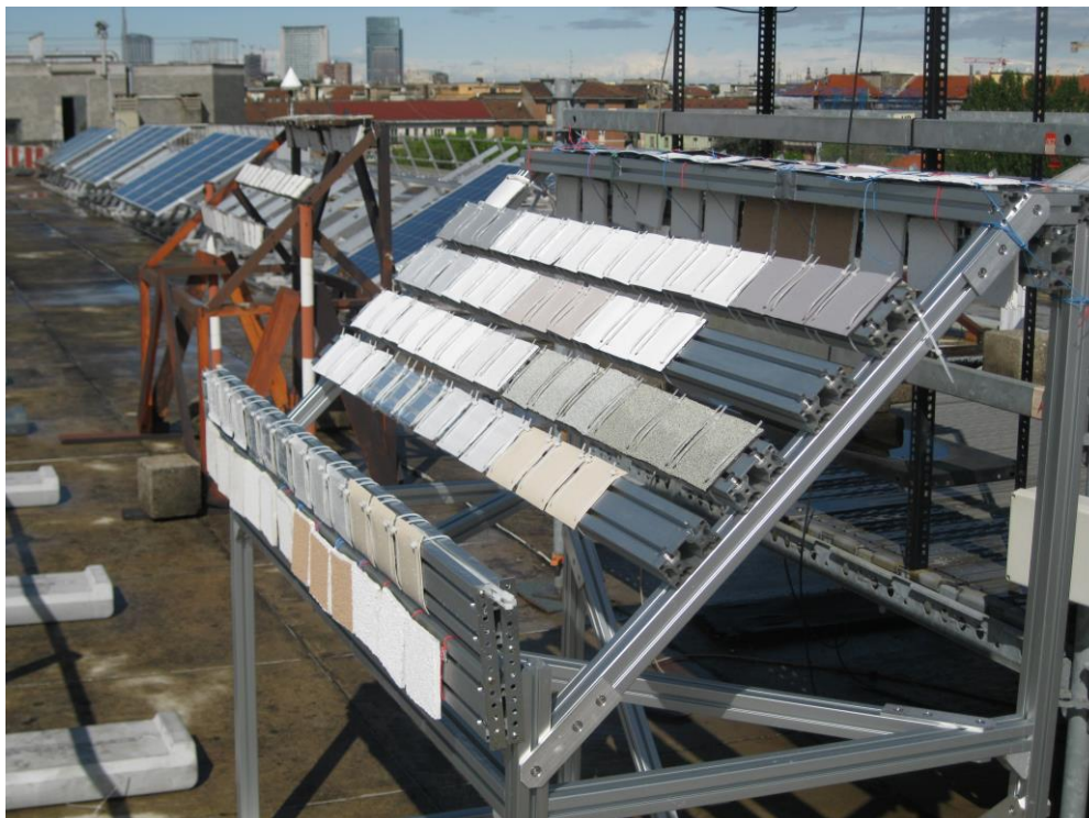
Figura 3. Telaio per l'esposizione naturale e visione d'insieme dei provini esposti
