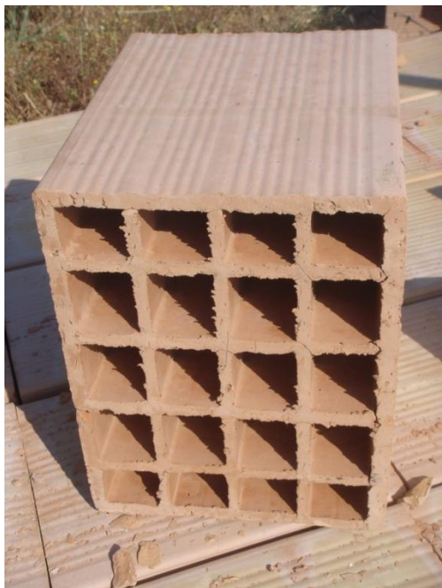
Figura 2.2.1: Il mattone forato usato per la realizzazione delle pareti in scala presso il campo sperimentale dell'Università di Bari.
