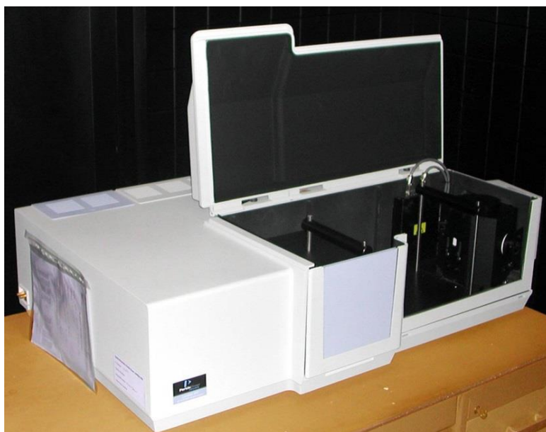
Figura 14 Spettrofotometro Perkin Elmer Lambda 900, Stazione Sperimentale del Vetro di Murano-Venezia.
