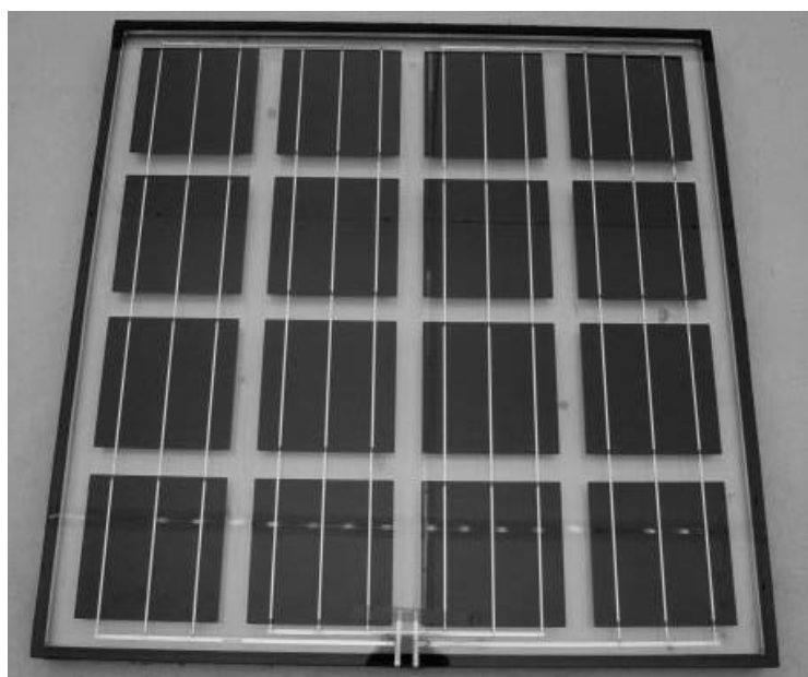
Figura 11 – Vetrocamera fotovoltaica, percentuale dell'area coperta da celle pari a 60%.
