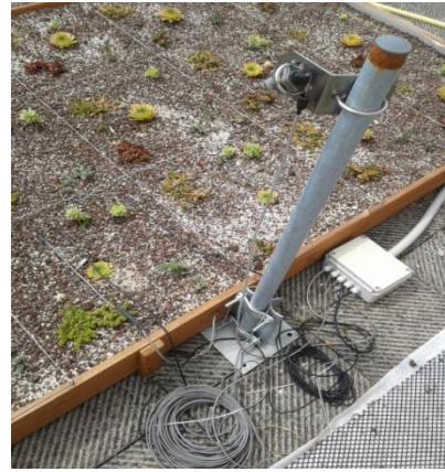
Foto 4, prototipo di verde estensivo con sensoristica
