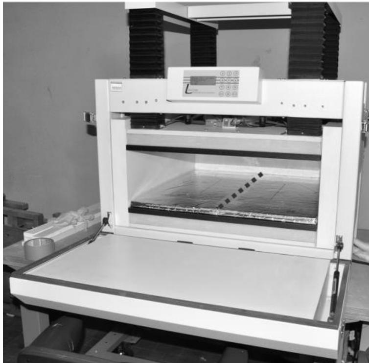
**Figura 2-11. Pannelli con giunto all'interno dell'apparato termoflussimetrico**
