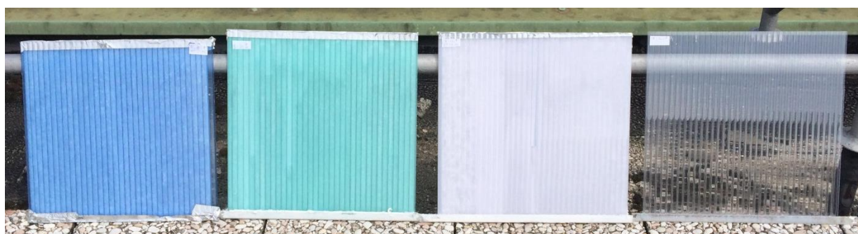
Figura 14 Configurazione 1-variante colore con PCM a base paraffina, temperatura di fusione 35°C. Da sinistra pannello Blu P_PCM 35, Verde P_PCM 35, Opale P_PCM 35 e il riferimento cristallo vuoto.
