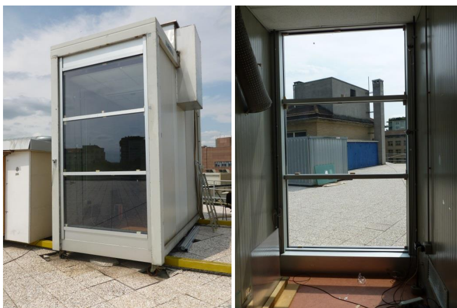
Figura 32 Test cell con i soli vetrocamera vista interna ed esterna.
