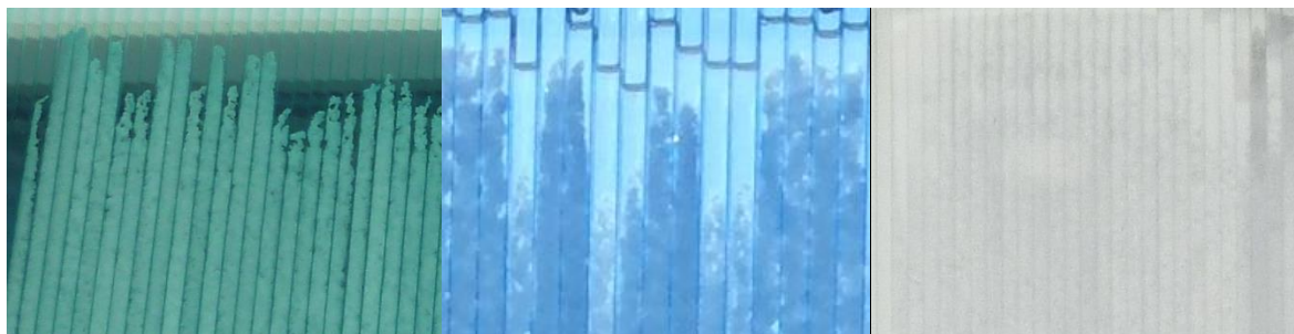
Figura 37 Configurazione 1. Analisi della transizione di fase. Polycarbonato alveolare verde contenente P_PCM 35 a). Polycarbonato alveolare blu contenente P_PCM 35 b). Polycarbonato alveolare opale contenente P_PCM 35 c).
