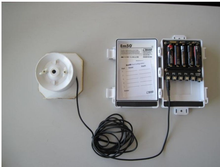
Figura 1: Termo-Igrometro (sinistra) e scheda di acquisizione.
