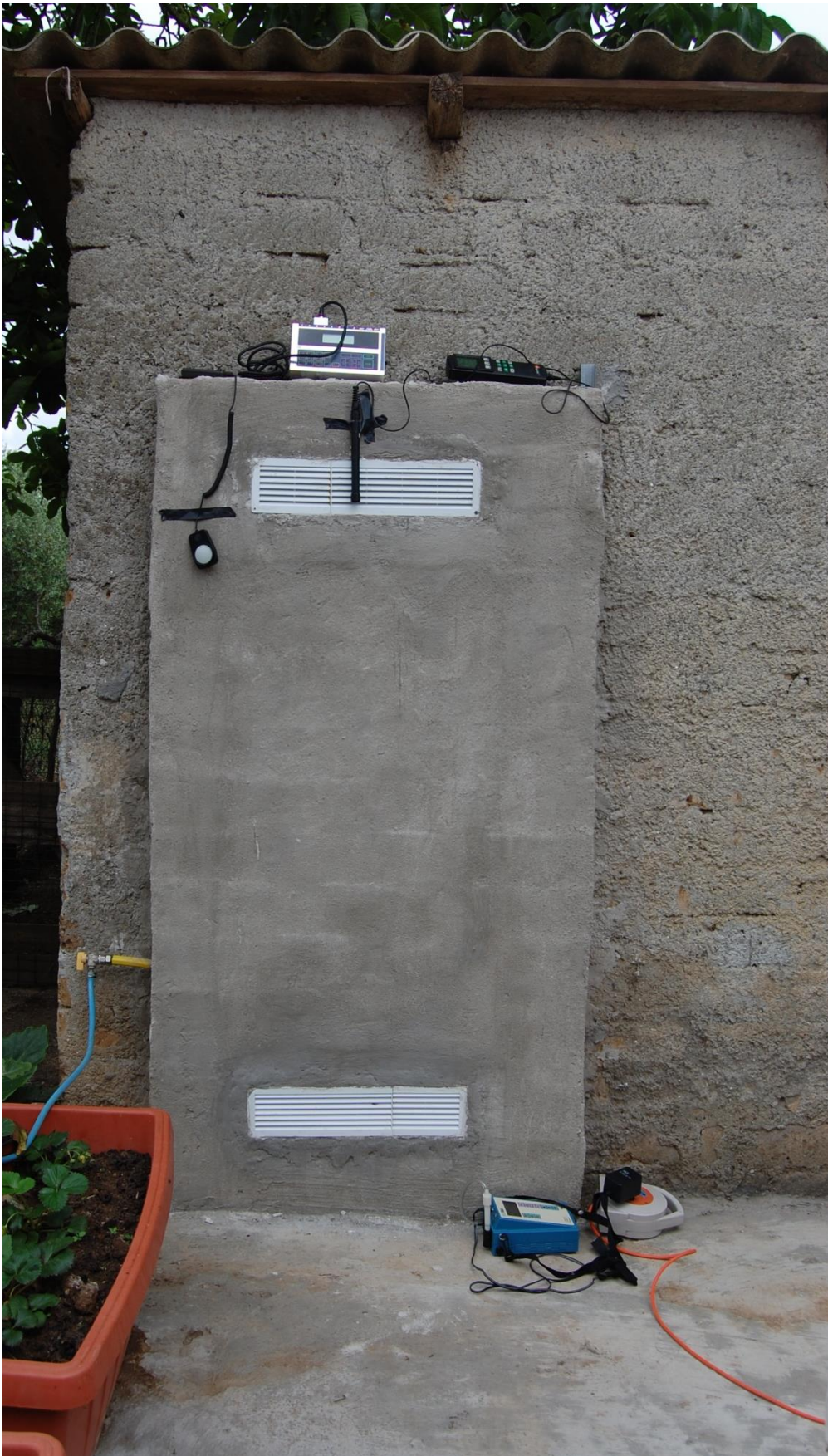
Figura 5. Sezione di prova strumentata del modulo di parete ventilata di altezza 1,5 metri
