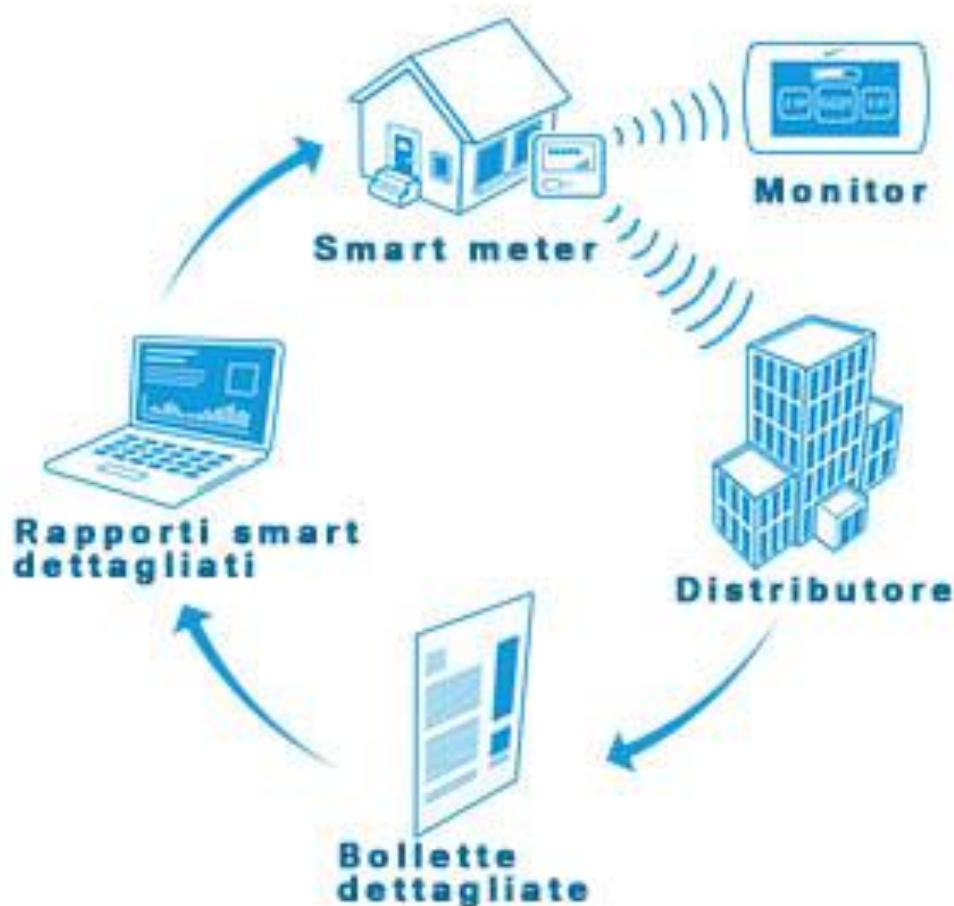
Figura 7. Schema del funzionamento dello smart metering
