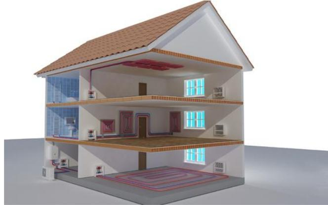
**Figura 38. Sistemi di riscaldamento a pannelli radianti**
