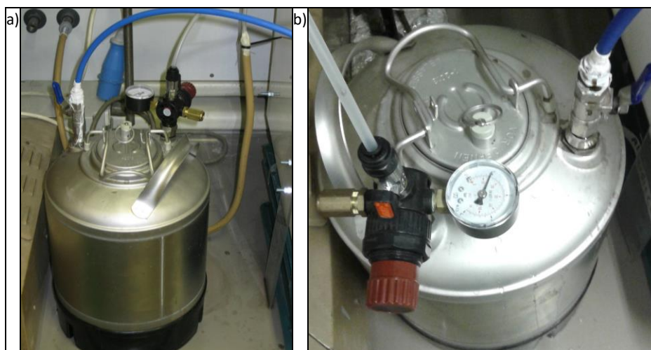
Figura 6. a) Serbatoio utilizzato al Politecnico di Milano per la nebulizzazione; b) dettaglio del serbatoio utilizzato e valvole. Il serbatoio deve essere dotato di valvole di sicurezza e di un manometro.
