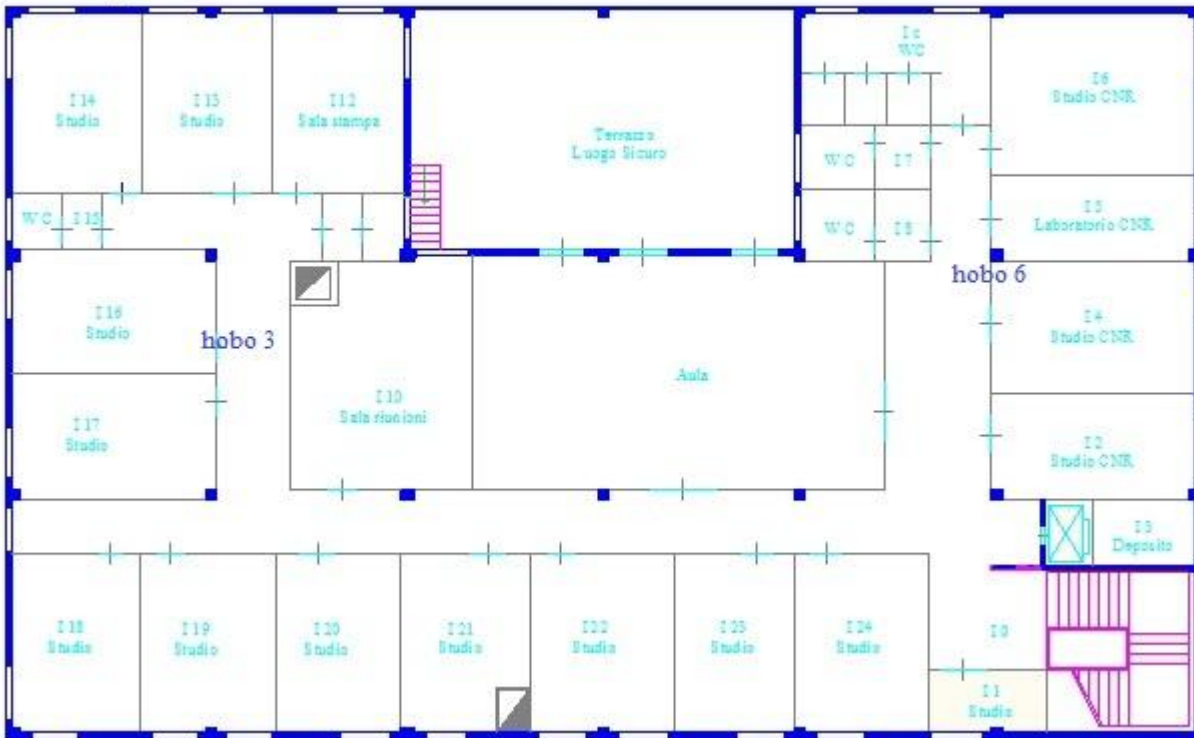
Figura 14: Posizionamento sensori HOB0 ai piani seminterrato e primo
