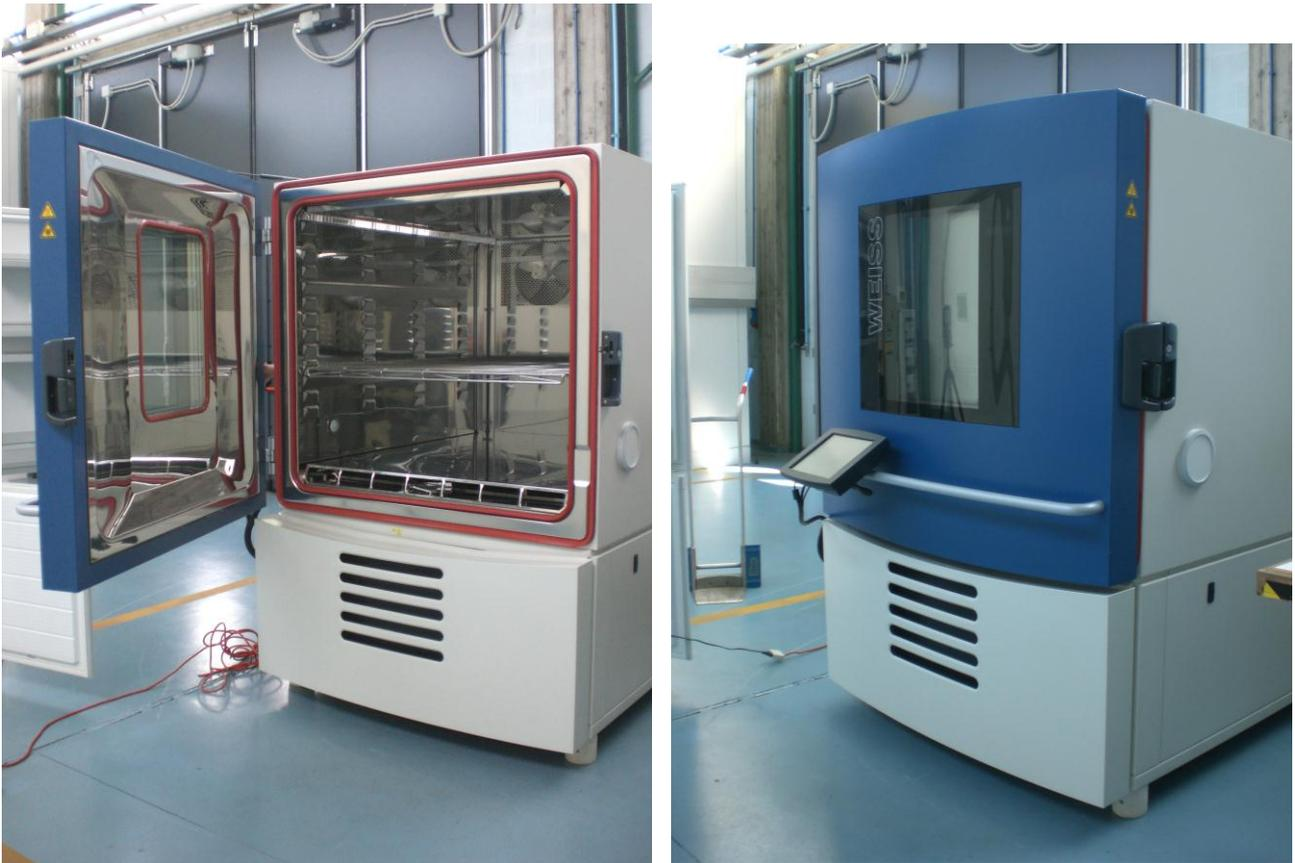
**Figura 3: la camera climatica a dimensioni ridotte CC3.**
