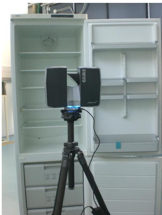
**Figura 9: Laser scanner posizionato per misura volume**
