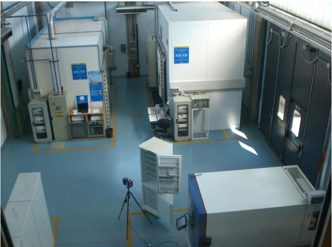
**Figura 2: Laboratorio di prova visto dall'alto con le tre camere climatiche.**
