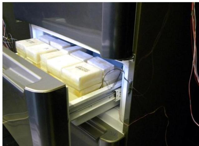
**Figura 6: Termoresistenze all'interno dell'elettrodomestico del freddo**
