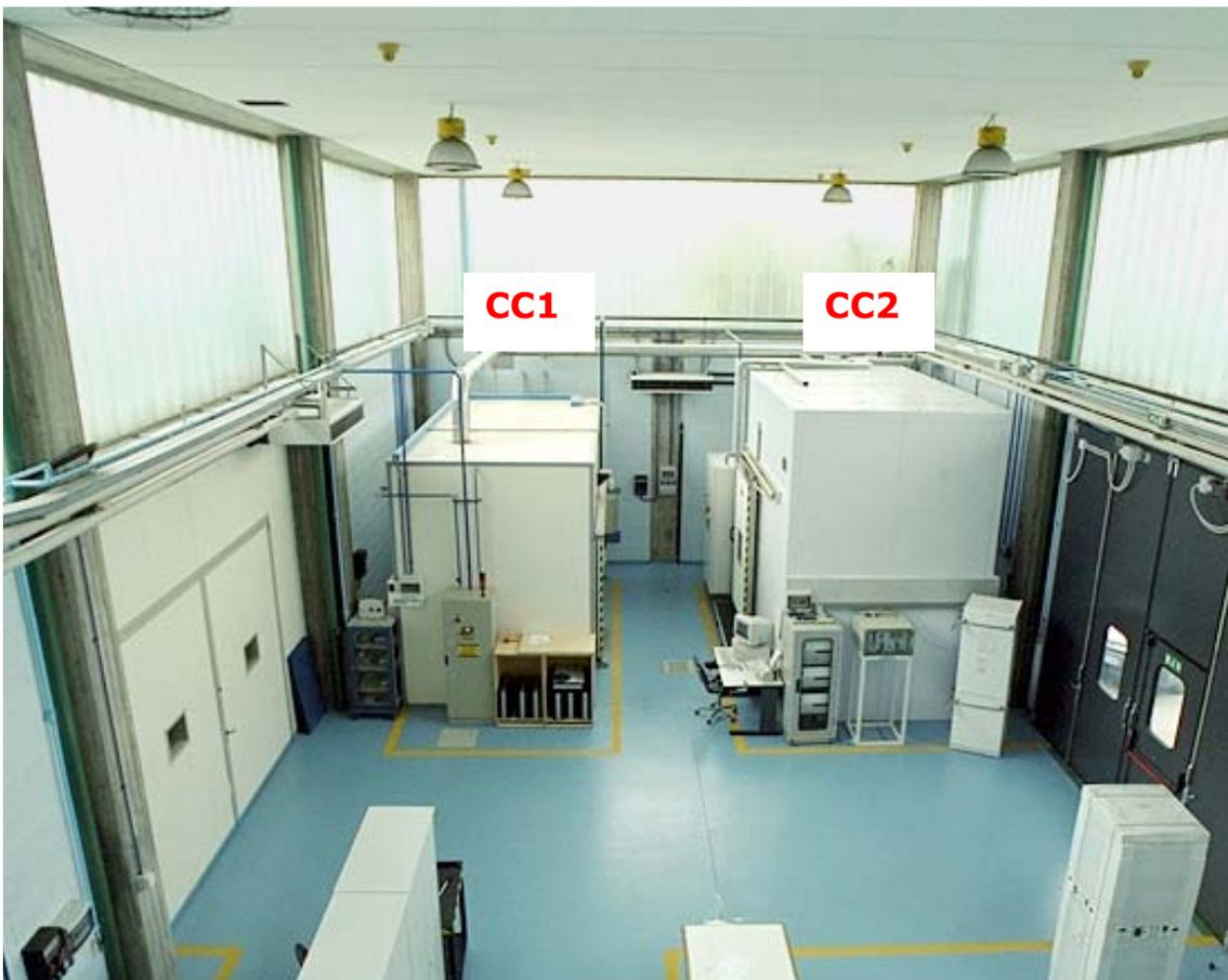
Figura 1: Laboratorio di prove visto dall'alto con le due camere climatiche (qui indicate con CC1 e CC2).
