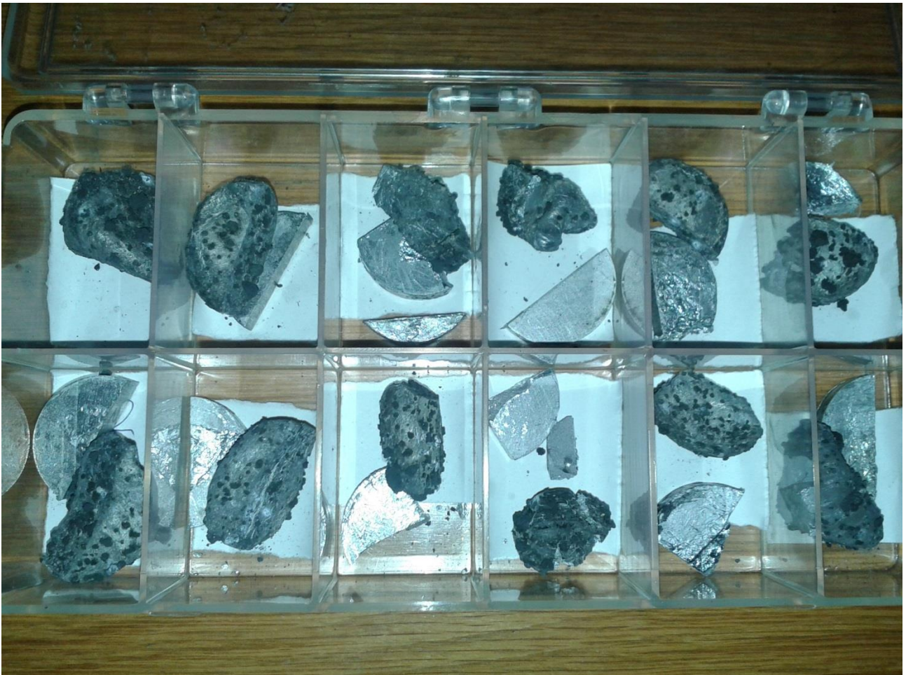
Figura 51: Risultati di schiumatura dei precursori eutettici sviluppati
