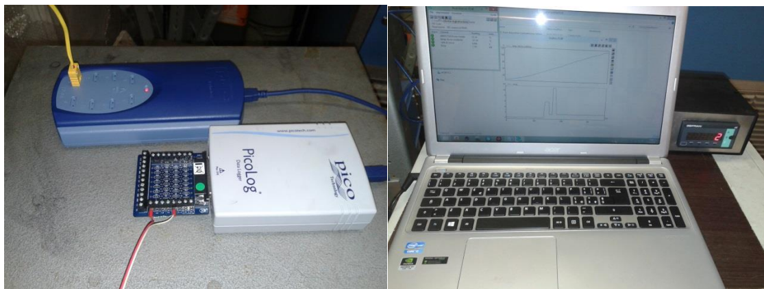
Figura 16: A sinistra i sistemi di acquisizione PICOLOG specifici per Termocoppie e tensioni.
