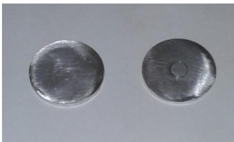
Figura 56: Dischetti diametro 30 mm e spessore 1,5 +/-0,2mm utilizzati per la realizzazione di compositi AFS
