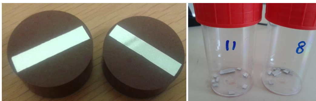
Figura 28: Preparazione dei campioni di precursore per analisi SEM e DSC
