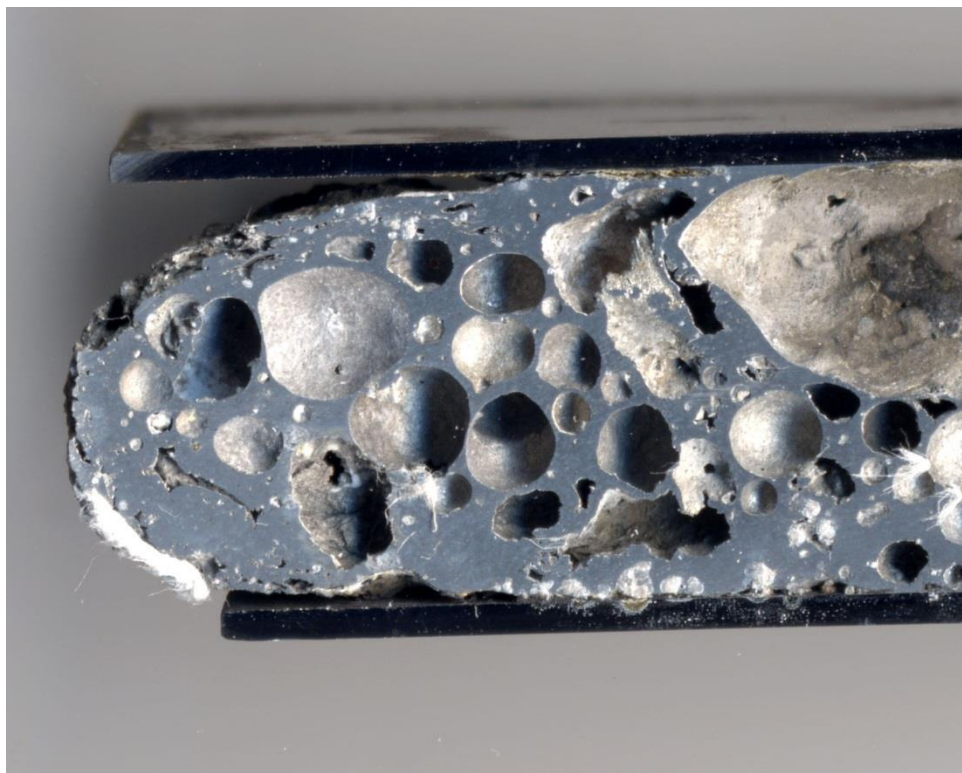
Figura 22. Distacco della lamina dalla schiuma sulla periferia delle mattonelle.
