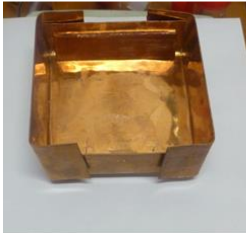
Figura 24. Contenitore di rame usato in alcuni test per schiumare i compositi precursori.
