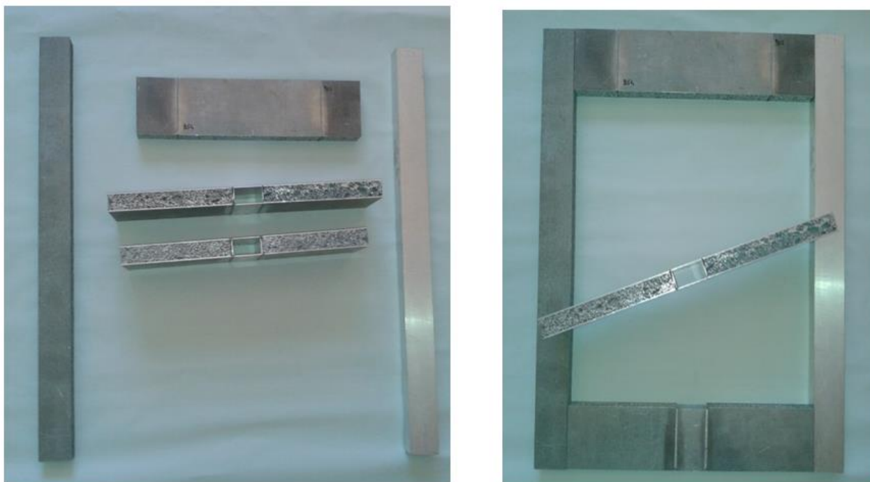
Figura 26: Simulacri di componenti alleggeriti ottenuti per assemblaggio di AFS e Profilati estrusi
