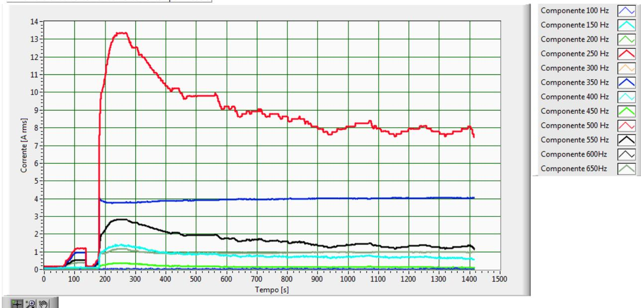
Fig.219–Andamento delle armoniche della corrente, fase S, con batteria al 90.0% di stato di carica iniziale
