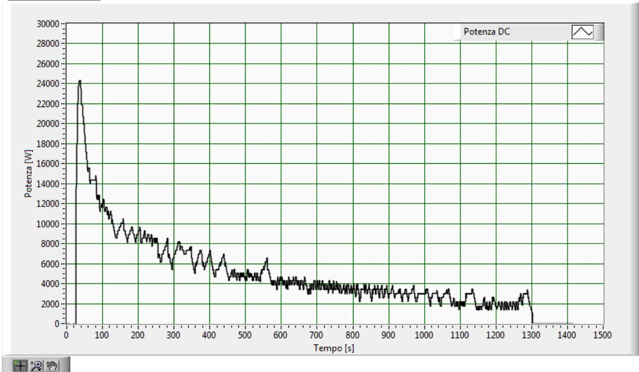
**Fig.204–Andamento della potenza DC di uscita con batteria al 90.0% di stato di carica iniziale**
