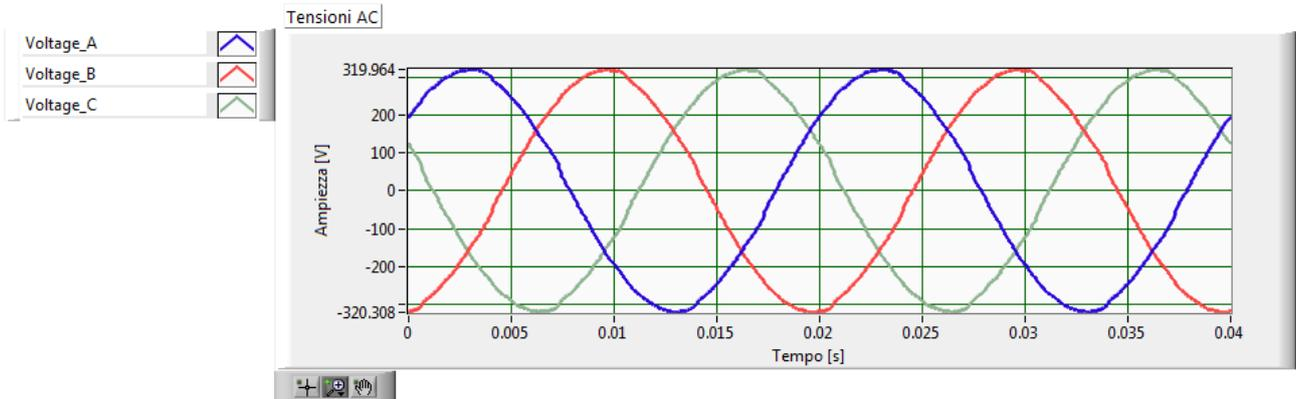
Fig.133 – Forme d’onda di tensione AC nel dominio del tempo, con sistema di conversione in modalità di funzionamento a tensione erogata costante
