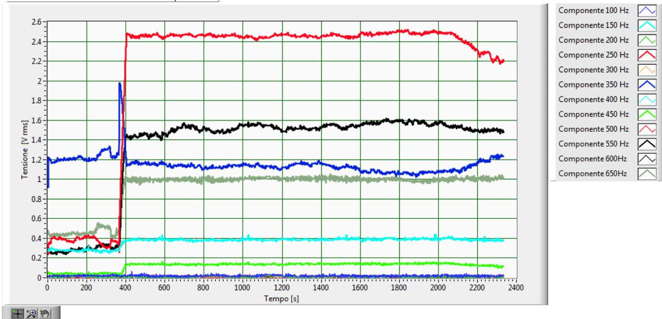
Fig.186–Andamento delle armoniche della tensione, fase T, con batteria al 54.9% di stato di carica iniziale
