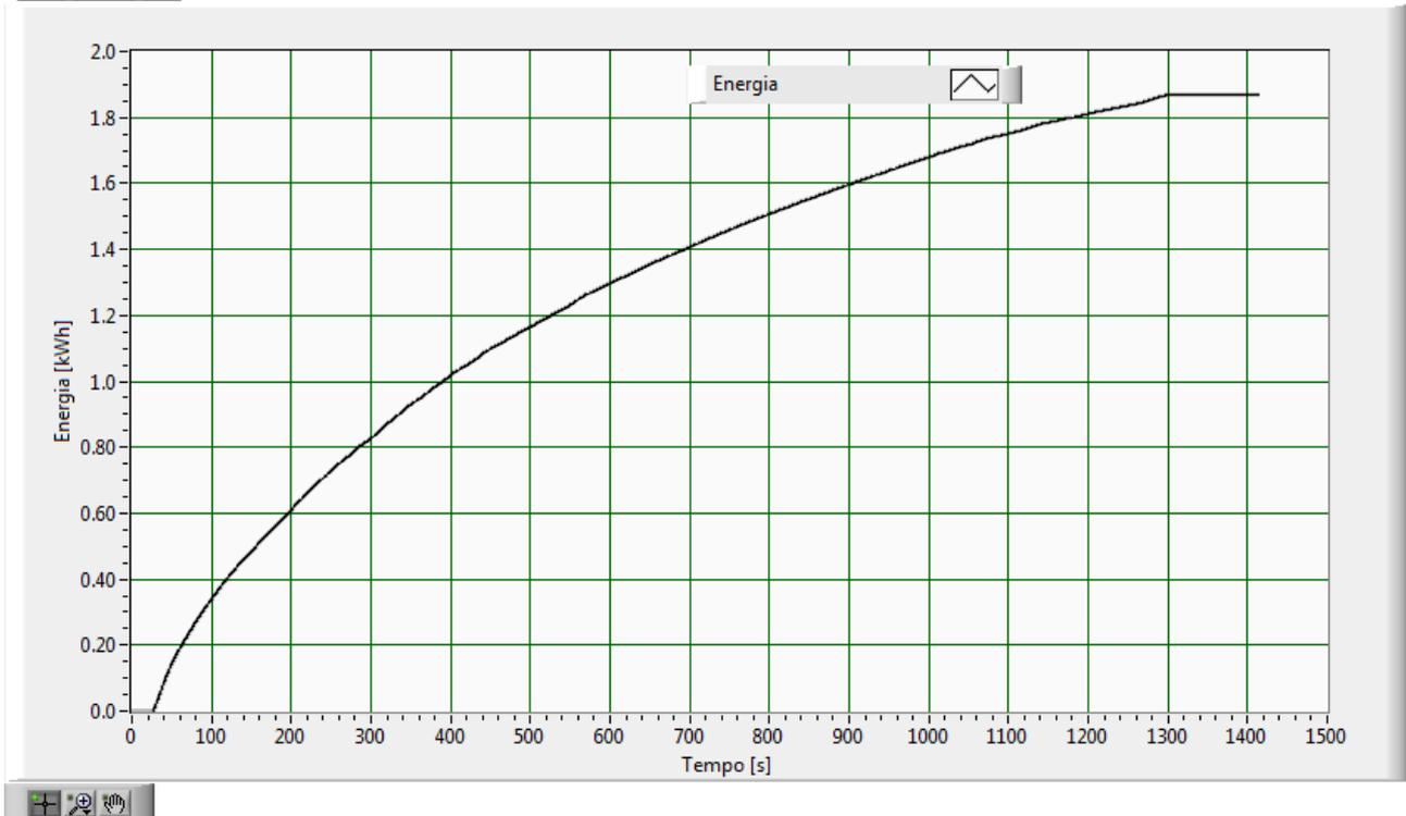
**Fig.205–Andamento della energia erogata uscita con batteria al 90.0% di stato di carica iniziale**
