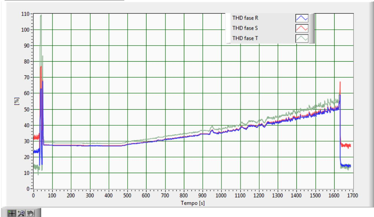
**Fig.159 –Andamento della distorsioni armoniche delle correnti, con batteria al 28.1% di stato di carica iniziale**
