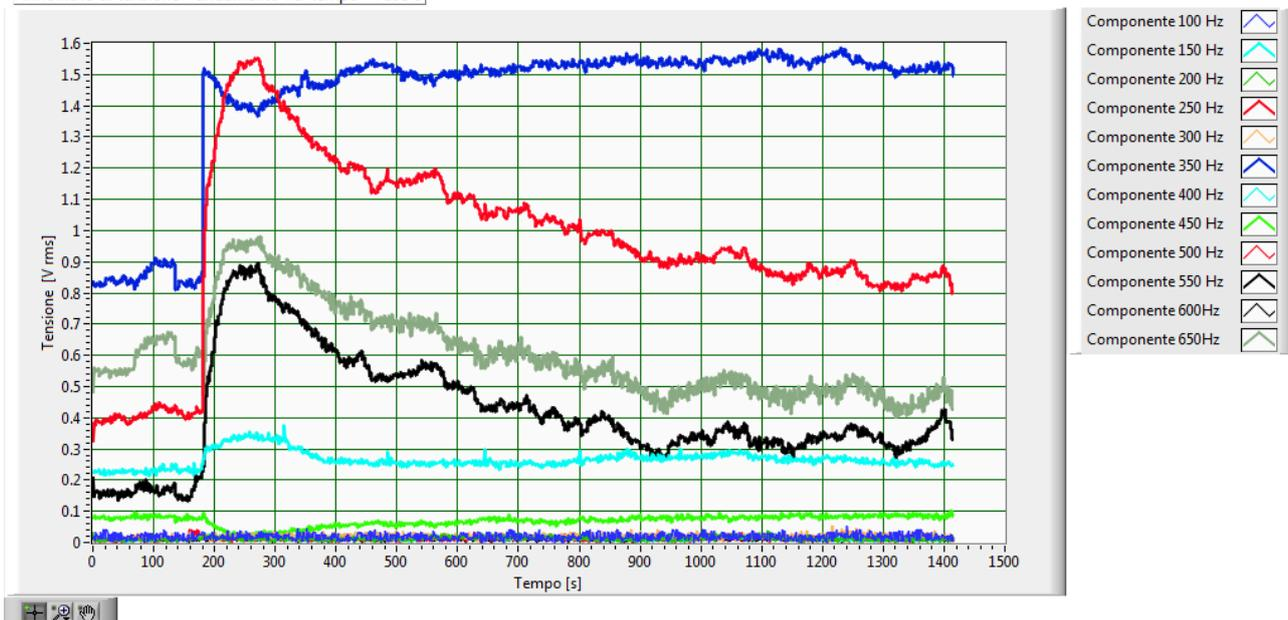
Fig.215–Andamento delle armoniche della tensione, fase S, con batteria al 90.0% di stato di carica iniziale
