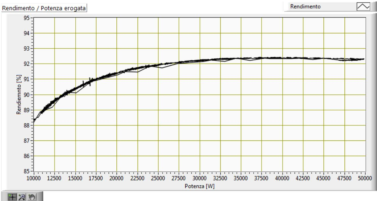
Fig.149–Andamento del rendimento in funzione della potenza erogata con batteria al 28.1% di stato di carica iniziale
