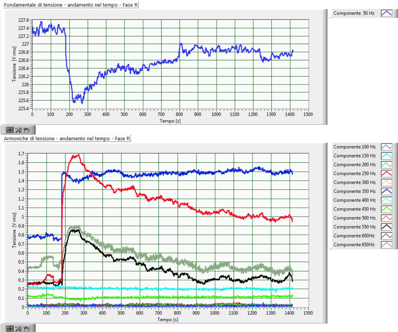
Fig.214–Andamento delle armoniche della tensione, fase R, con batteria al 90.0% di stato di carica iniziale
