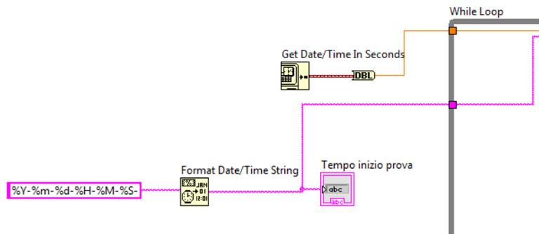
Fig. 41 - Codice di definizione dell'istante di inizio della prova
