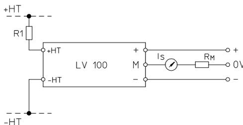
**Fig.14– Schema di collegamento del singolo trasduttore di tensione LV 100.**
