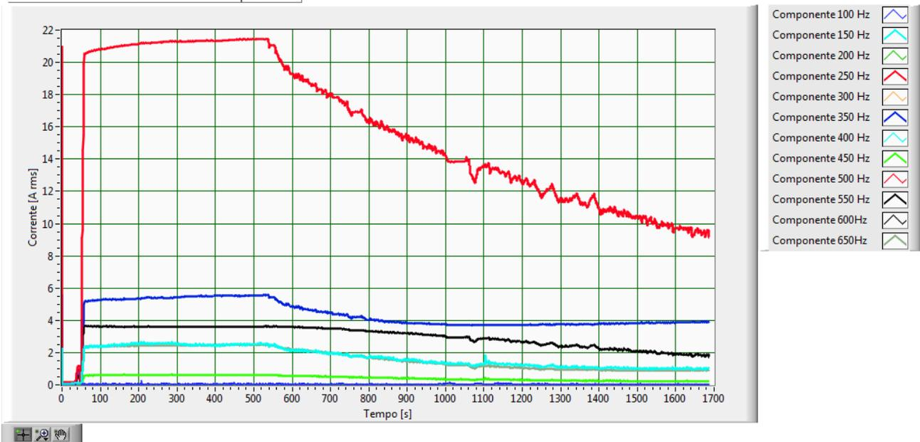
Fig.161–Andamento delle armoniche della corrente, fase S, con batteria al 28.1% di stato di carica iniziale
