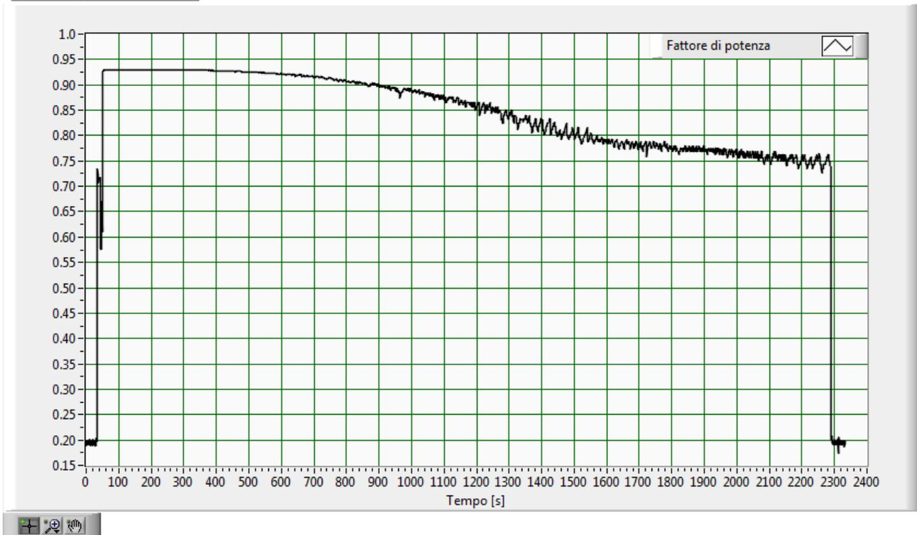
Fig.180–Andamento del fattore di potenza medio AC con batteria al 54.9% di stato di carica iniziale
