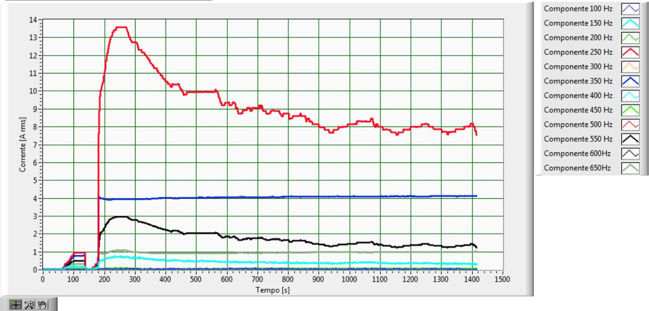
Fig.220–Andamento delle armoniche della corrente, fase T, con batteria al 90.0% di stato di carica iniziale
