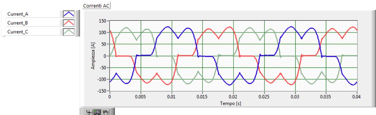
Fig.83 – Forme d’onda di corrente AC nel dominio del tempo, stato di carica residua al 28.1 %.
