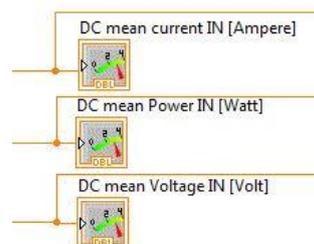
**Fig. 39 –Visualizzazione lato ingresso dei valori medi di corrente, tensione e potenza.**
