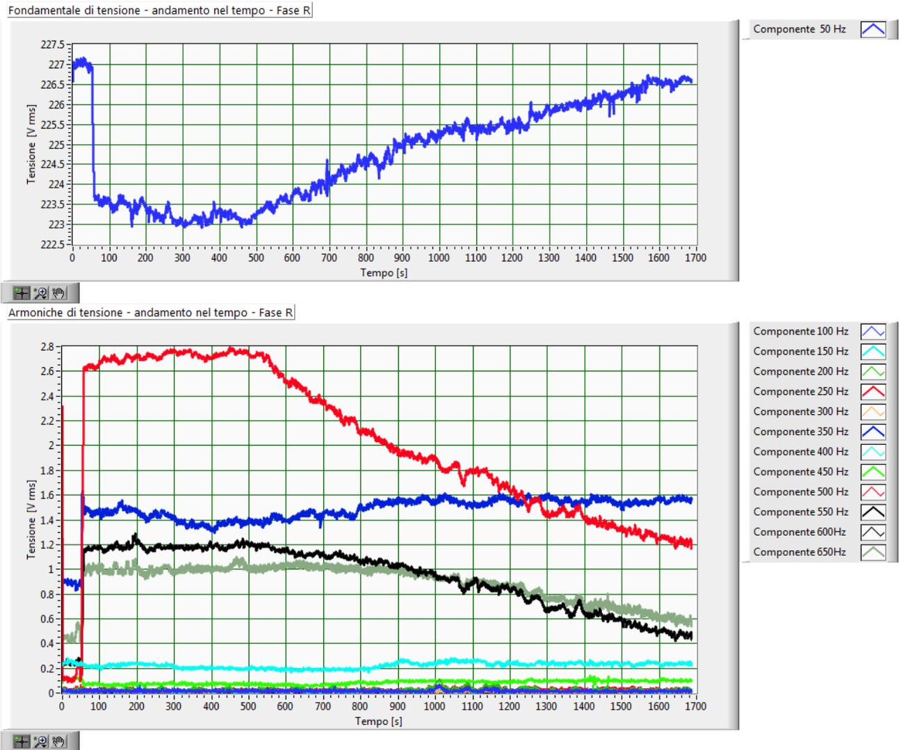
Fig.156–Andamento delle armoniche della tensione, fase R, con batteria al 28.1% di stato di carica iniziale
