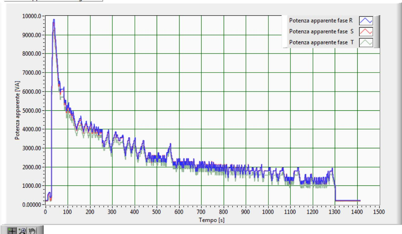
Fig.222–Andamento delle potenze apparenti di fase, con batteria al 90.0% di stato di carica iniziale
