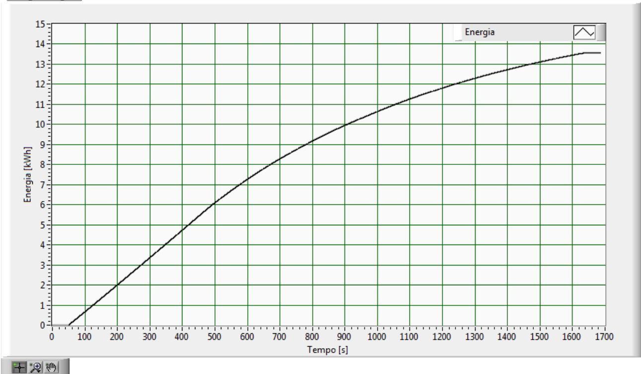
**Fig.147–Andamento della energia erogata uscita con batteria al 28.1% di stato di carica iniziale**
