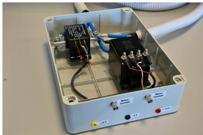
**Fig. 18 - Blocco di misura di tensione e corrente lato DC**
