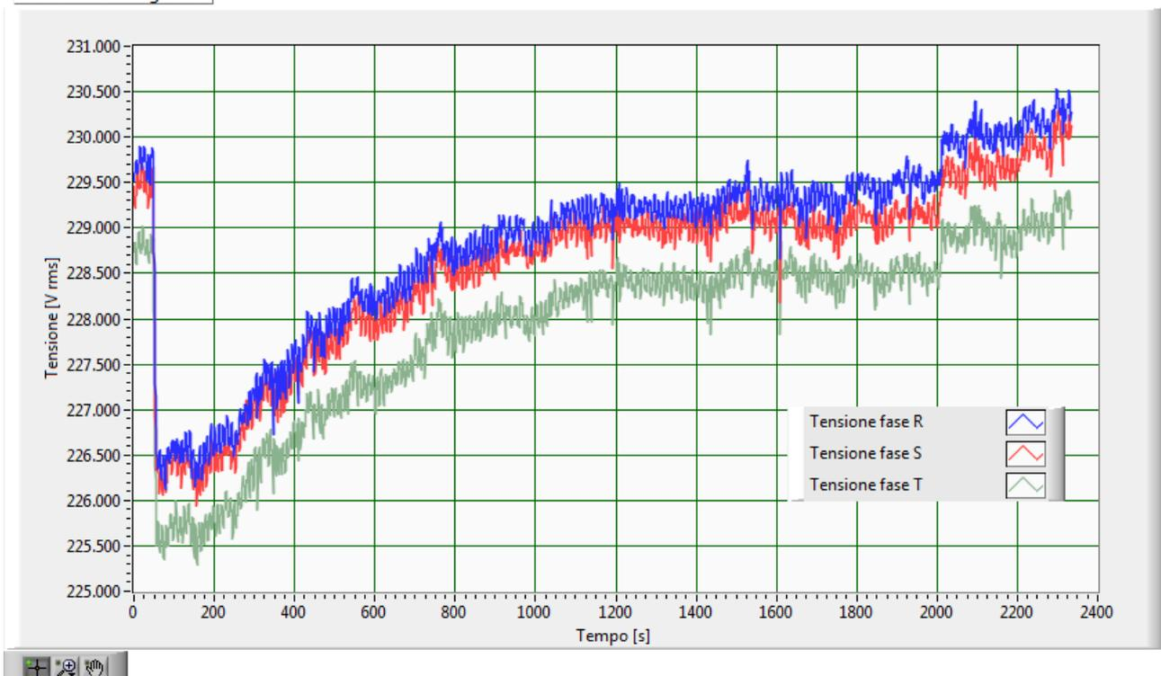
Fig.181–Andamento delle tensioni efficaci AC con batteria al 54.9% di stato di carica iniziale
