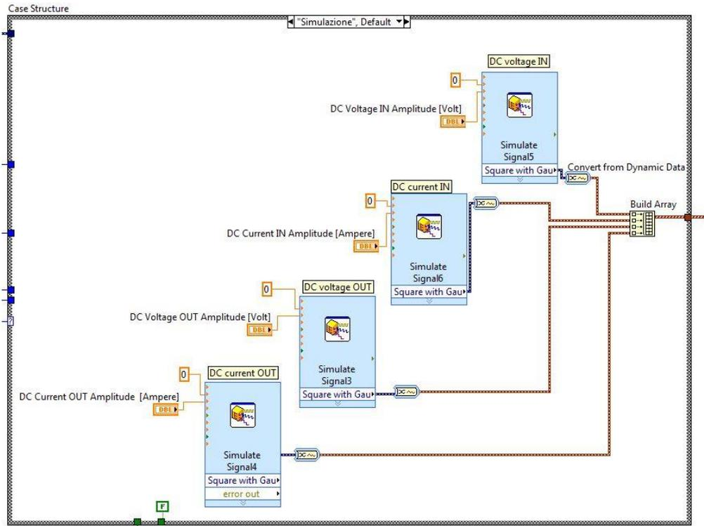
**Fig. 33 – Block diagram della sezione di simulazione**
