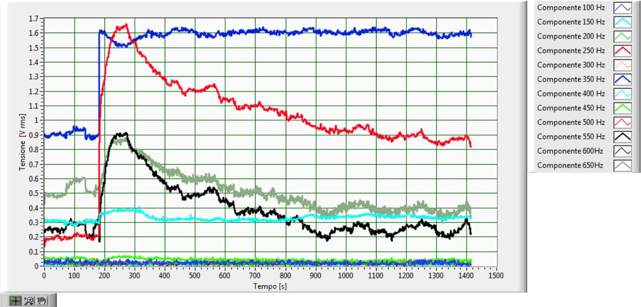
Fig.216–Andamento delle armoniche della tensione, fase T, con batteria al 90.0% di stato di carica iniziale
