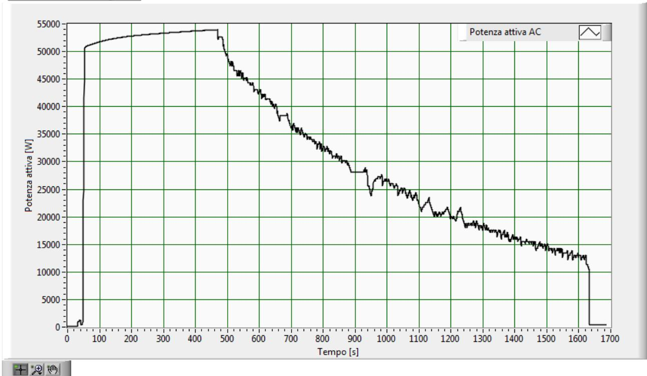
Fig.150–Andamento della potenza attiva AC con batteria al 28.1% di stato di carica iniziale
