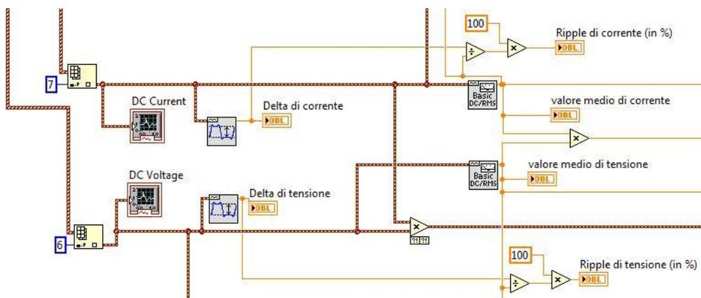
**Fig. 59 – Visualizzazione di tensione e corrente nel lato DC di uscita nel dominio del tempo, con il calcolo del valor medio di V e I, il delta di V e I e il ripple percentuale di tensione e corrente.**
