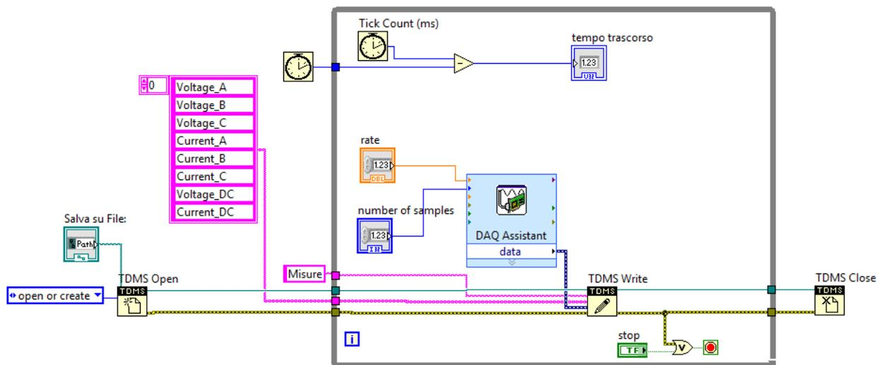
**Fig. 66- Block Diagram del sistema di acquisizione di lunga durata con ingresso in AC trifase.**
