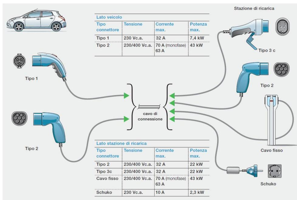
**Fig. 8 - connessioni possibili per il modo 3**
