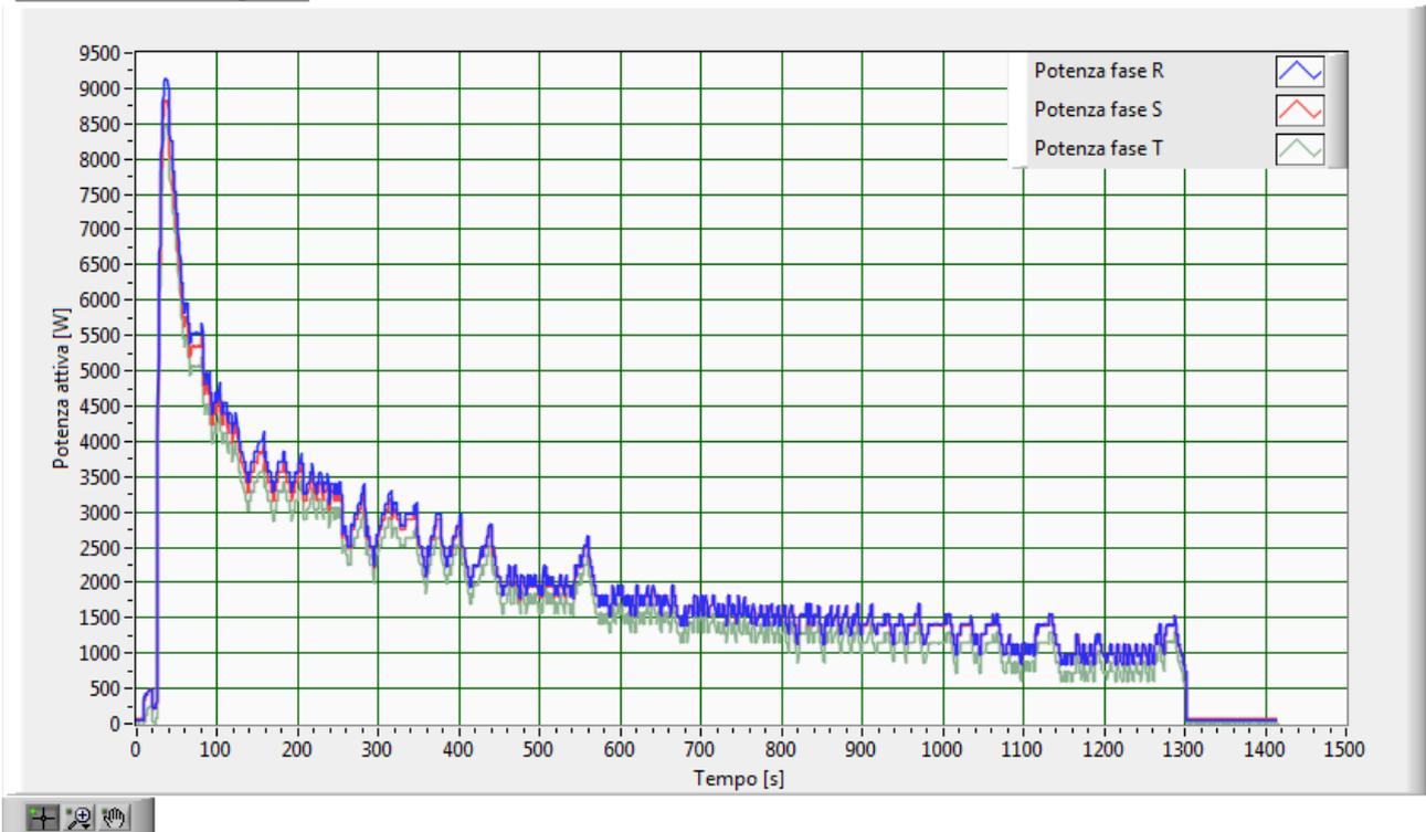
Fig.221–Andamento delle potenze attive di fase, con batteria al 90.0% di stato di carica iniziale
