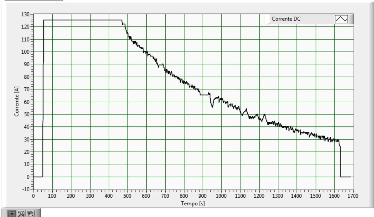
Fig.144–Andamento della corrente DC di uscita con batteria al 28.1% di stato di carica iniziale
