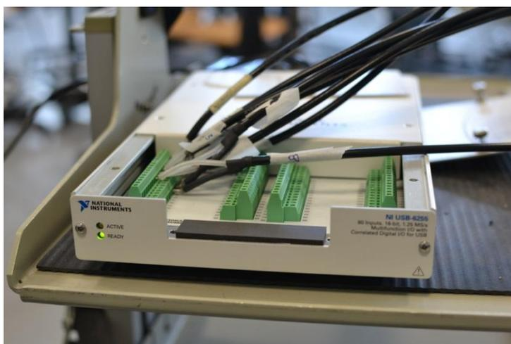
**Fig.20 – Scheda di acquisizione dati NI USB – 6255**
