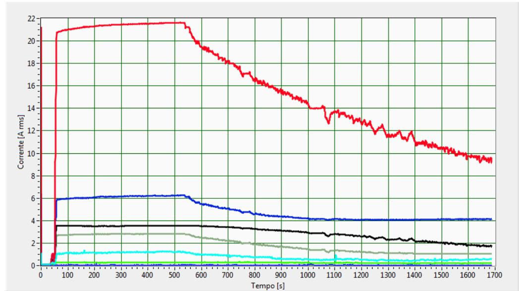
Fig.160–Andamento delle armoniche della corrente, fase R, con batteria al 28.1% di stato di carica iniziale
