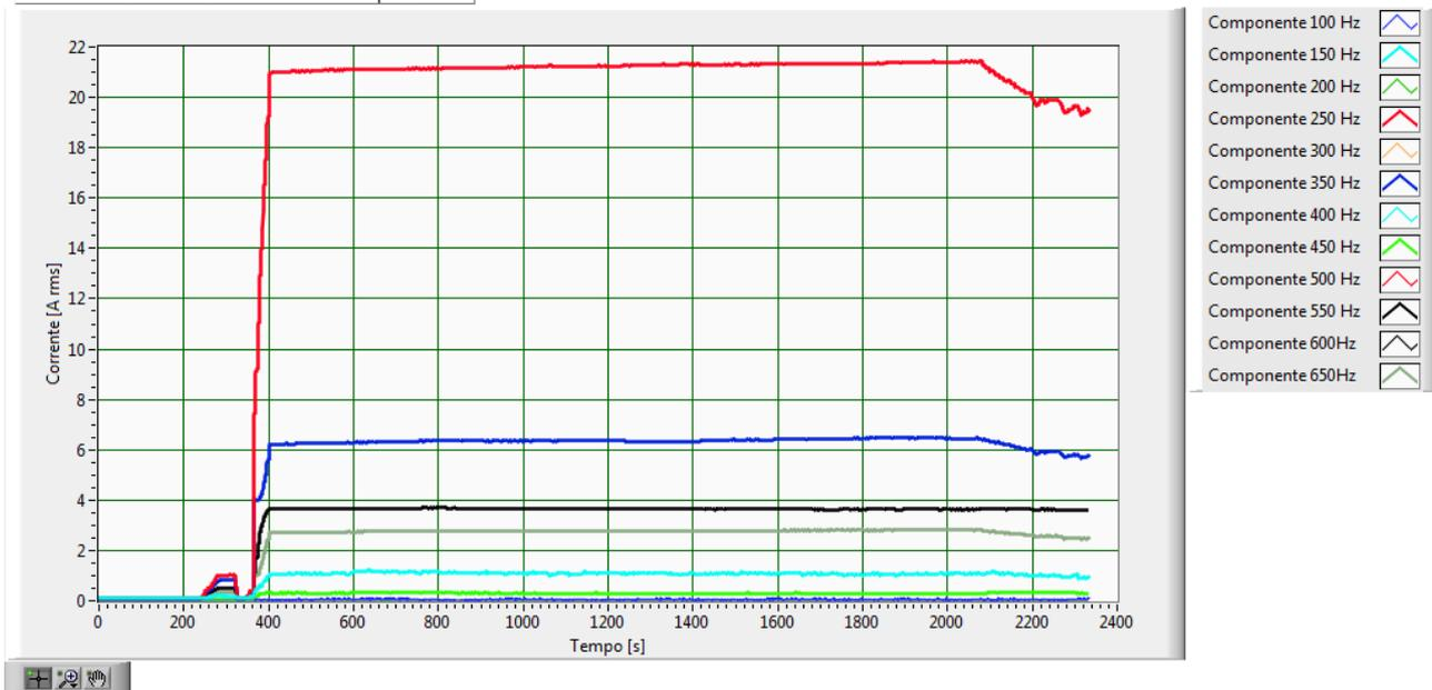
Fig.188–Andamento delle armoniche della corrente, fase R, con batteria al 54.9% di stato di carica iniziale
