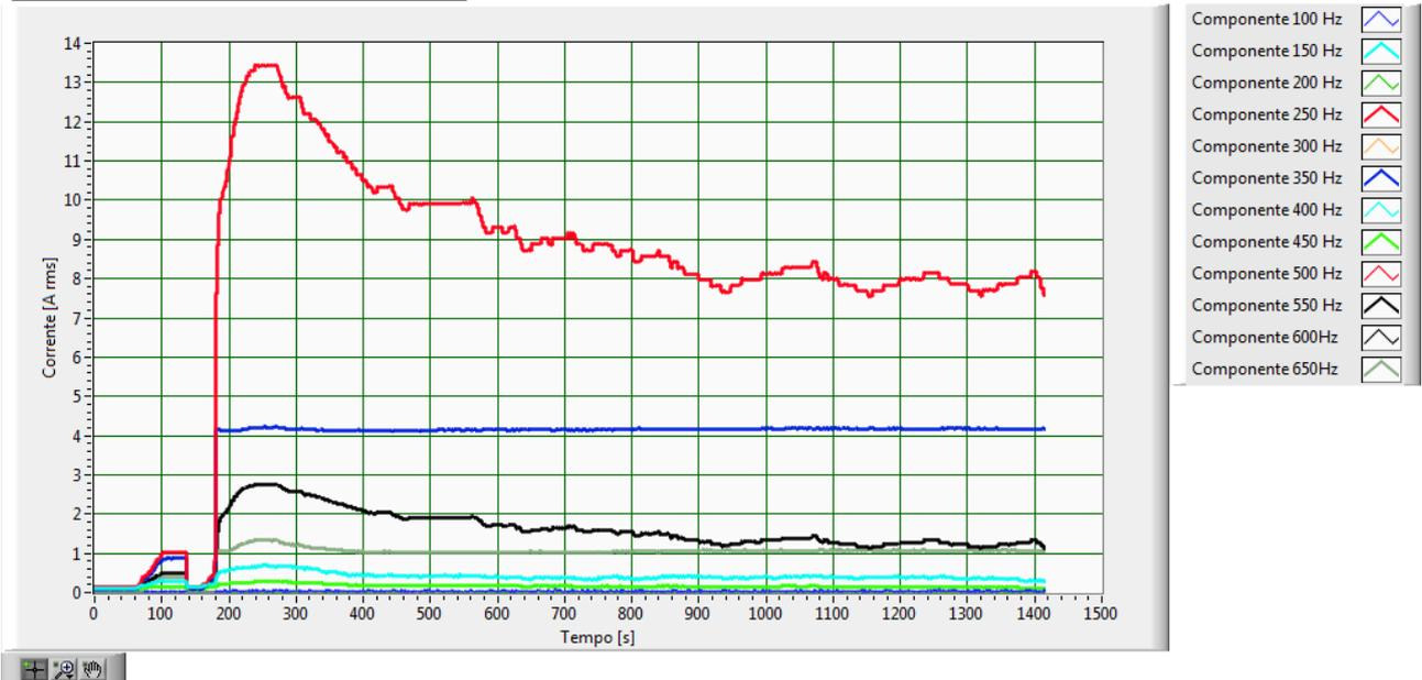
Fig.218–Andamento delle armoniche della corrente, fase R, con batteria al 90.0% di stato di carica iniziale
