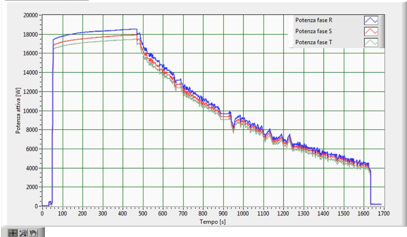
Fig.163–Andamento delle potenze attive di fase, con batteria al 28.1% di stato di carica iniziale
