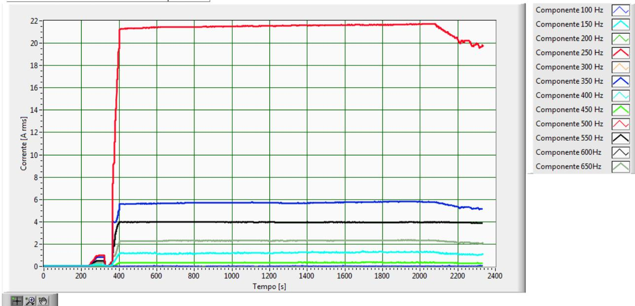
Fig.190–Andamento delle armoniche della corrente, fase T, con batteria al 54.9% di stato di carica iniziale
