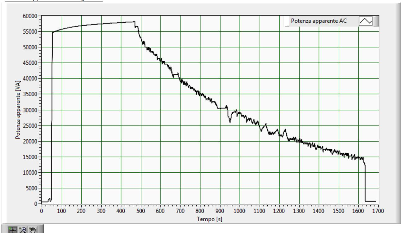
Fig.151–Andamento della potenza apparente AC con batteria al 28.1% di stato di carica iniziale
