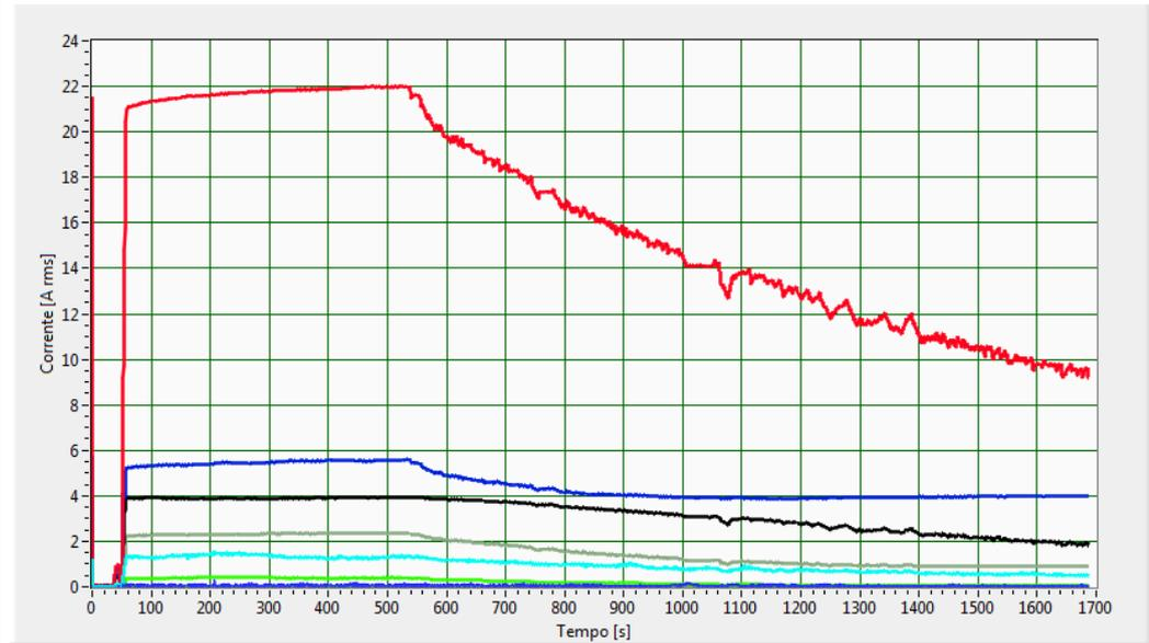
Fig.162–Andamento delle armoniche della corrente, fase T, con batteria al 28.1% di stato di carica iniziale
