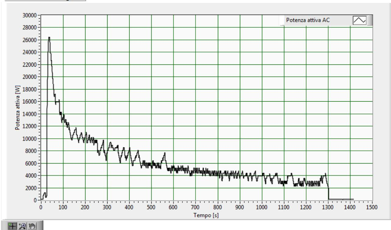
**Fig.208**–Andamento della potenza attiva AC con batteria al 90.0% di stato di carica iniziale
