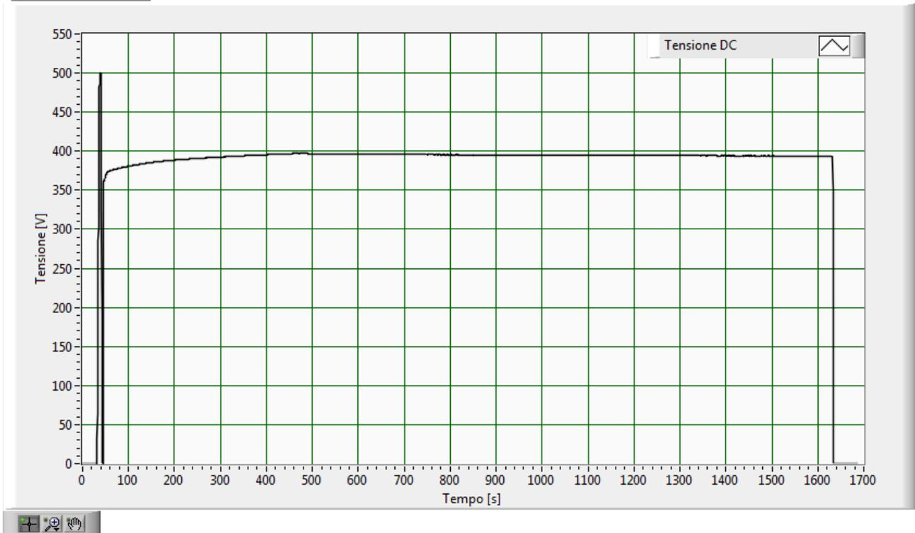
Fig.143 –Andamento della tensione DC di uscita con batteria al 28.1% di stato di carica iniziale
