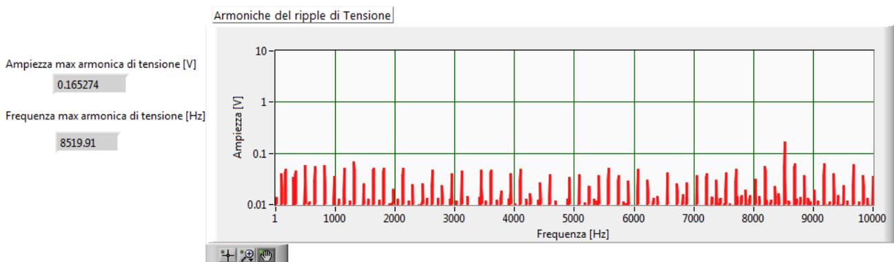
**Fig.88 – Forme d’onda di tensione DC nel dominio della frequenza, stato di carica residua al 28.1 %.**
