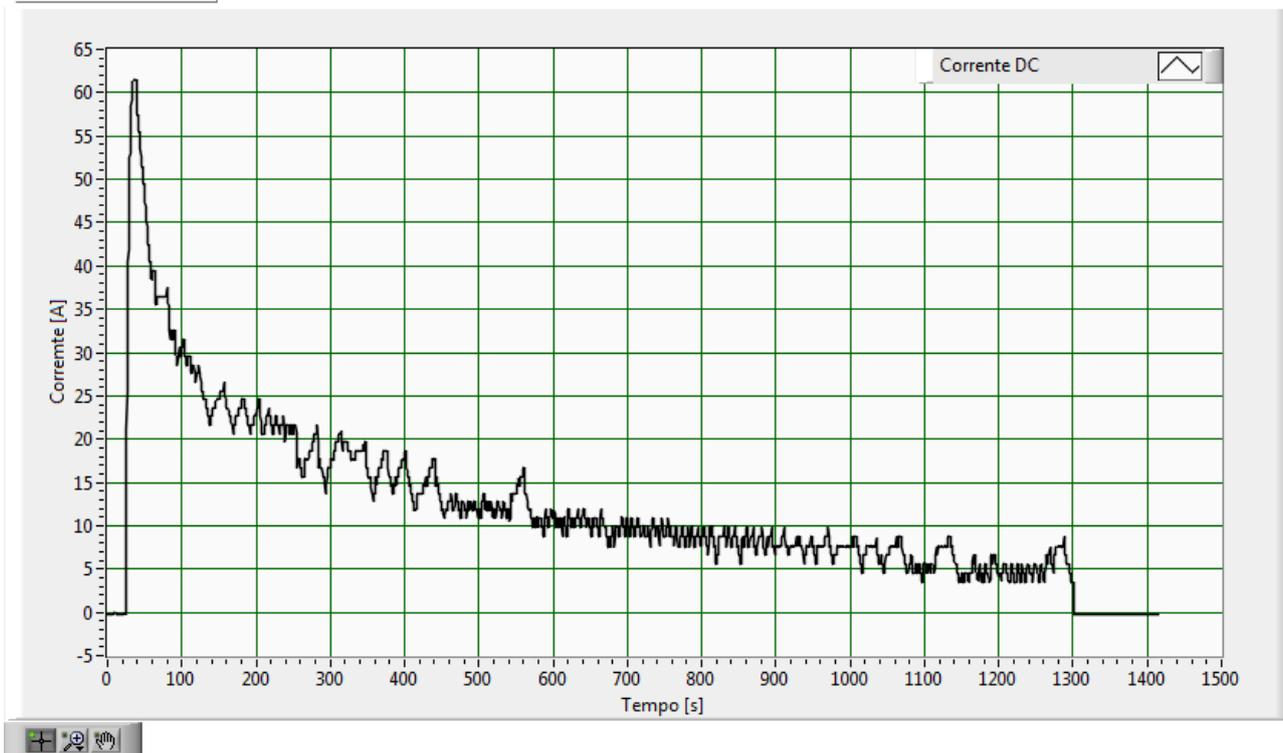
Fig.202–Andamento della corrente DC di uscita con batteria al 90.0% di stato di carica iniziale
