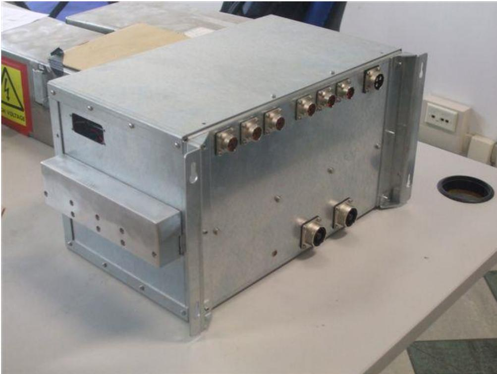
**Figura 7 . Blocco di potenza del caricabatterie integrale**
