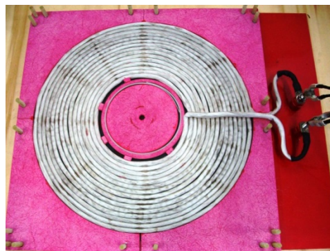
Figura 2.3.1.2. Foto di una bobina senza piatto di copertura.
