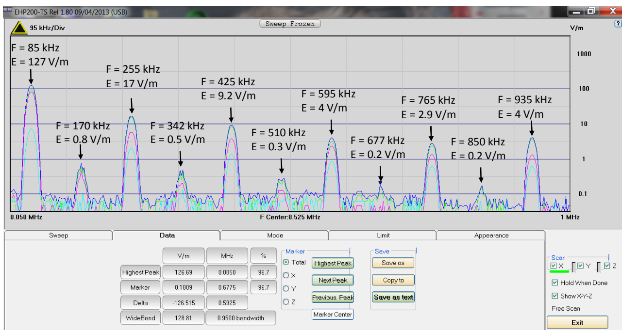
Figura 9: spettro del campo E misurato nel punto 5 su una banda 50 kHz – 1 MHz.
