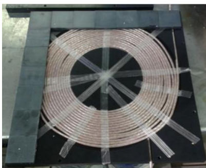
Figura 7. Bobina ricevente e trasmittente del prototipo realizzato a Padova
