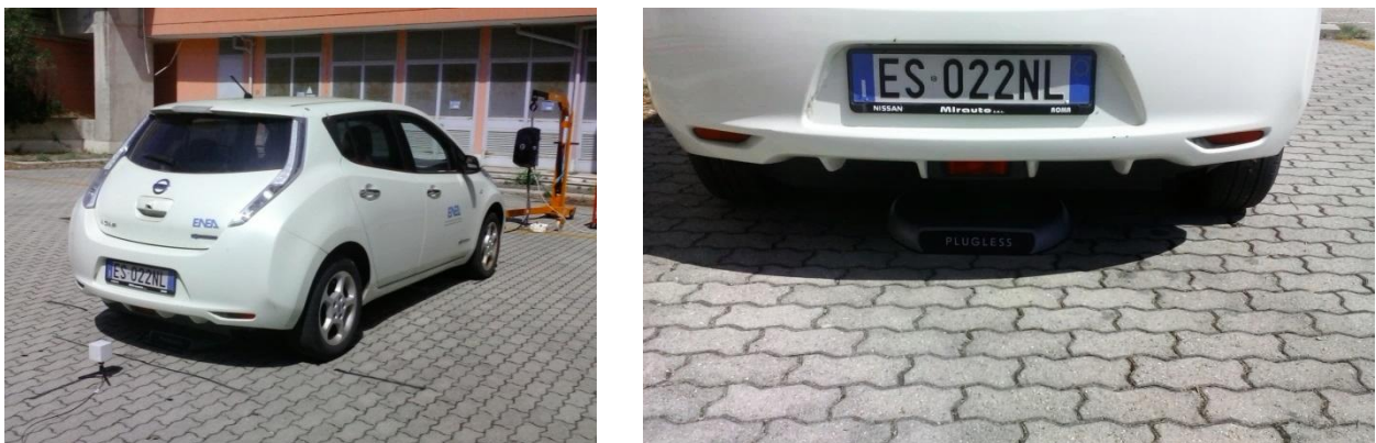
Figura 5. Misure di campo elettrico e magnetico all’esterno del veicolo e dettaglio della bobina trasmittente.
