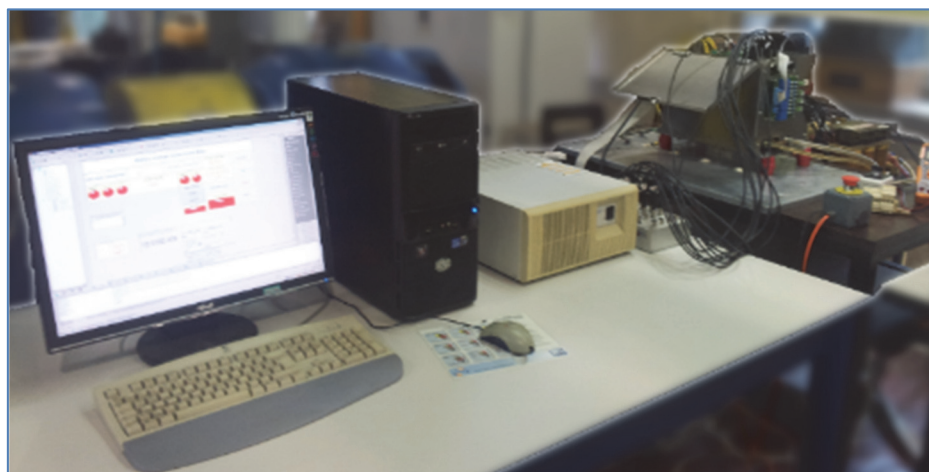
Figura 20. Host PC e dSpace DS1005 board per l'implementazione del controllo digitale del convertitore.
