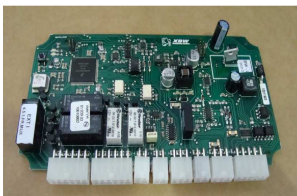
Figura 26. Scheda master (sinistra) ed unità slave (destra).
