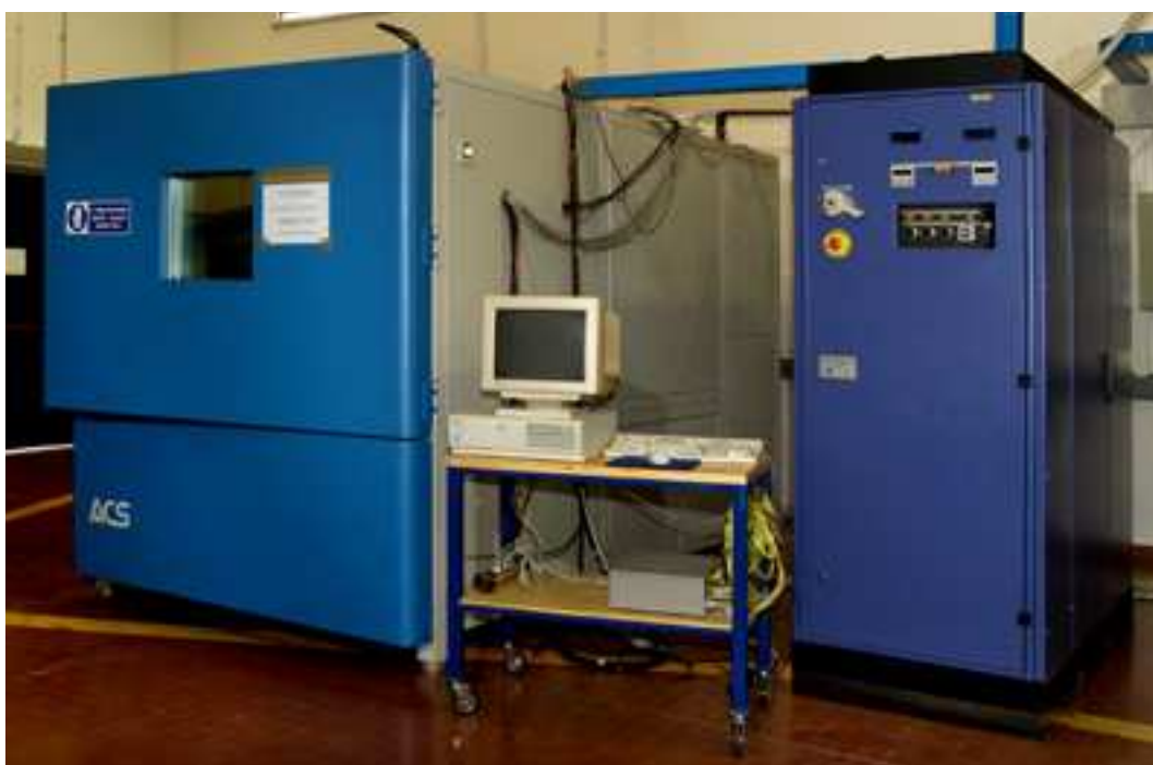
Figura 13. Dispositivi impiegati per le prove sul sistema “pilota”: camera climatica (sinistra), ciclatore (destra), sistema di acquisizione dati (centro).
