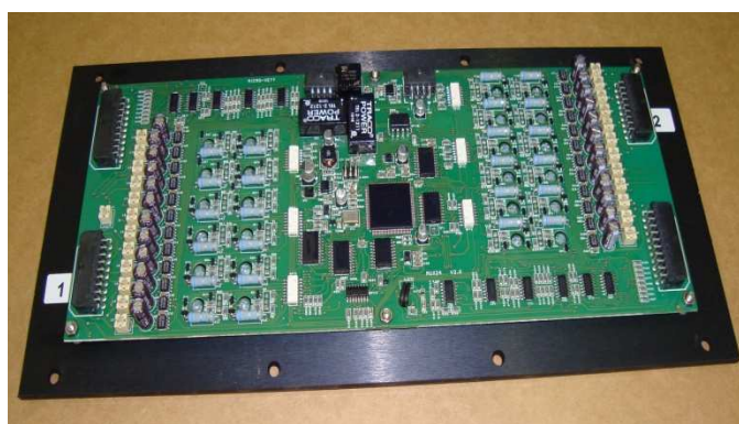
Figura 26. Scheda master (sinistra) ed unità slave (destra).
