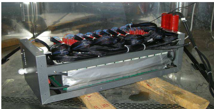
Figura 12. Batteria in prova KOKAM da 74 celle al litio in serie, usata come sistema “pilota”.
